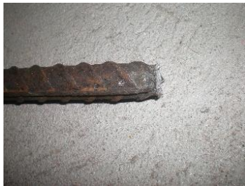
b) Ruptura do conector no 2ª ensaio de teste.
