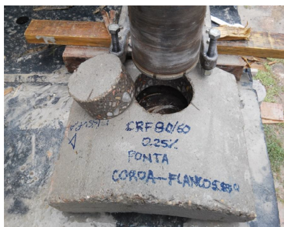
Figura 3.16 – Corpos-de-prova extraídos com extratora da faixa entre coroa e flanco esquerdo do tubo.
