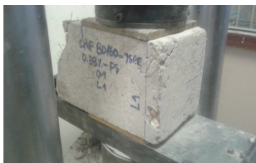
Figura 3.12 - Ensaio de compressão modificada em L_1 com fratura no terço médio da amostra.
