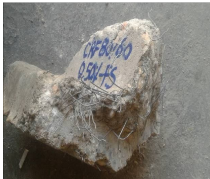
Figura 2.20 – Ouriço na bolsa do tubo com fibras soltas do tipo 80/60 com teor de 0,50%.
