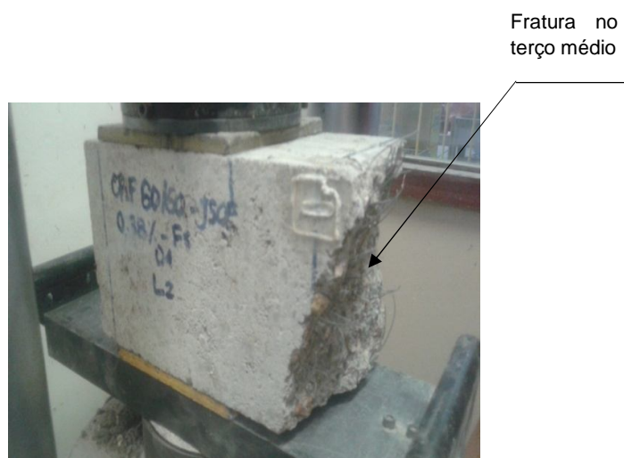
Figura 3.13 - Ensaio de compressão modificada em L 2 com fratura no terço médio da amostra.
