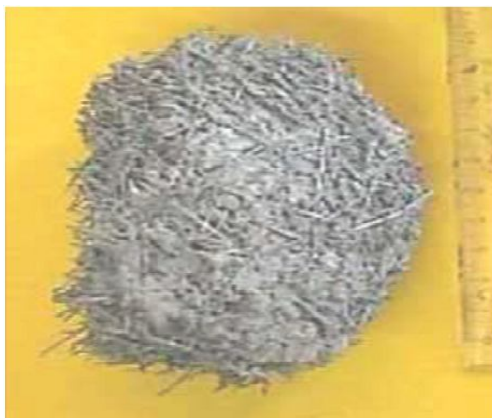
Figura 2.17 – Ouriço formado por fibras de aço mal misturadas ao concreto (FIGUEIREDO, 2000).
