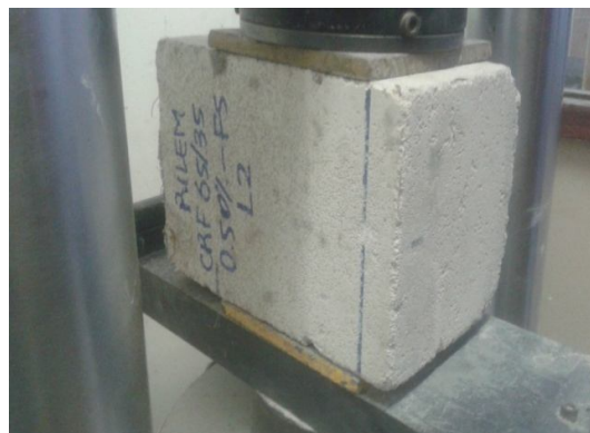
Figura 3.10 - Ensaio de compressão modificada em L_2 . Amostra com fratura no entalhe para indução de fissura no meio do vão.
