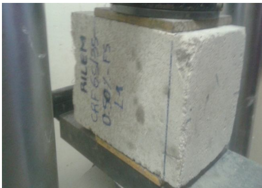
Figura 3.9 – Ensaio de compressão modificada em L_1 . Amostra com fratura no entalhe feito para indução de fissura no meio do vão.
