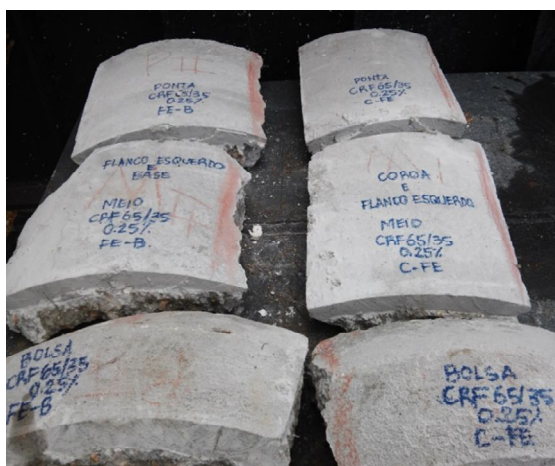
Figura 3.15 – Faixas retiradas com serra circular da parede do tubo.
