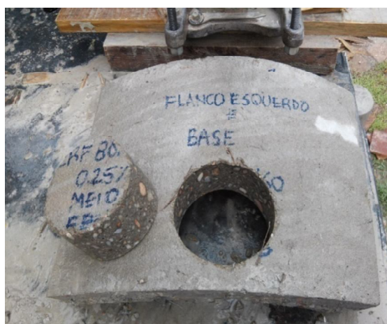
Figura 3.17 - Corpos-de-prova extraídos com extratora da faixa entre base e flanco esquerdo do tubo
