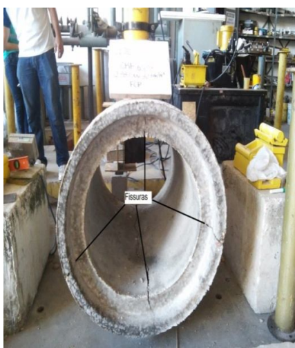
Figura 4.1 – Plano de fissuração do tubo
