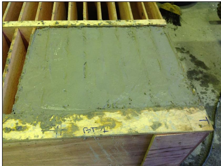
Após os 90 dias da confecção, as placas foram preparadas para receber o revestimento através de limpeza com escovação manual com escova de aço a seco e depois com escova com cerdas plásticas e água. Para minimizar o efeito da variável mão de obra, que não faz parte da pesquisa, a execução do revestimento será feita horizontalmente e o adensamento será realizado através de mesa vibratória, a fim de obter homogeneização da camada.
