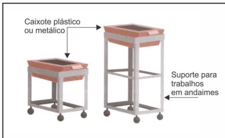
FIGURA 29 - Caixaote plástico com suporte metálico para colocação de alvenaria
