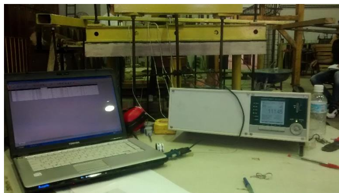
Figura 4.35 - Sistema de aquisição de dados
