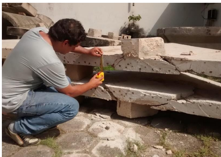
Figura 5.24 – Determinação das alturas úteis das lajes
