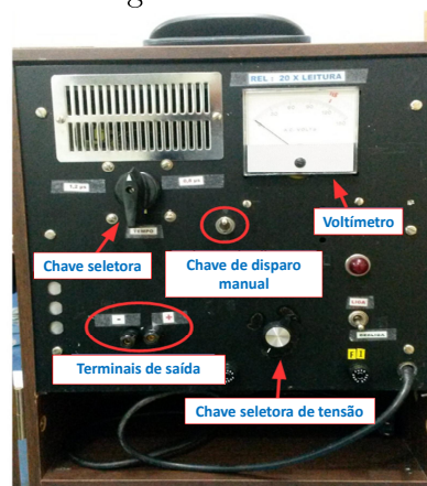
Figura 11: Painel frontal do gerador de surto utilizado nos experimentos.
