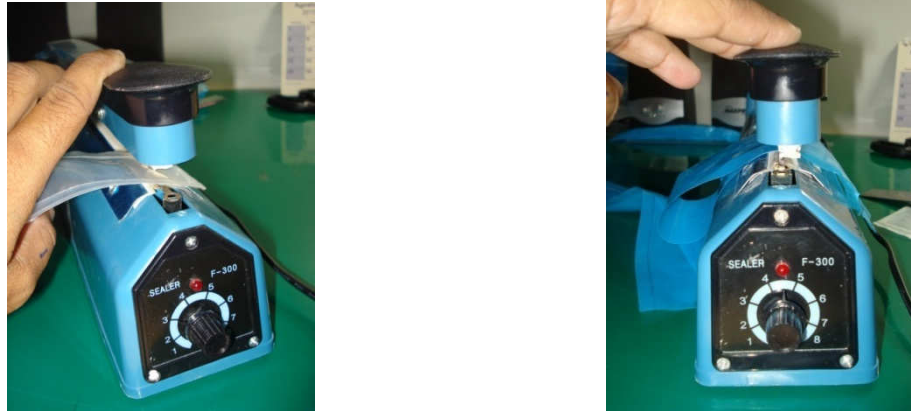
Figura 3.11: Processo de Soldagem dos Três Tipos de Filmes de Polietilenos.
