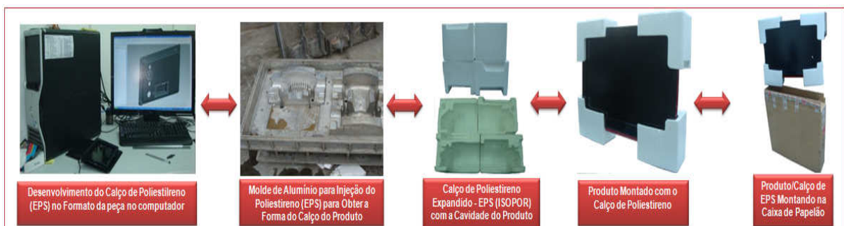
Figura 3.17: Processo de Desenvolvimento dos Calços de Poliestireno (EPS).
