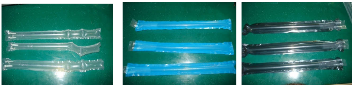
Figura 3.13: Amostras das Colunas de Ar Infladas dos Três Tipos de Filme de Polietileno.
