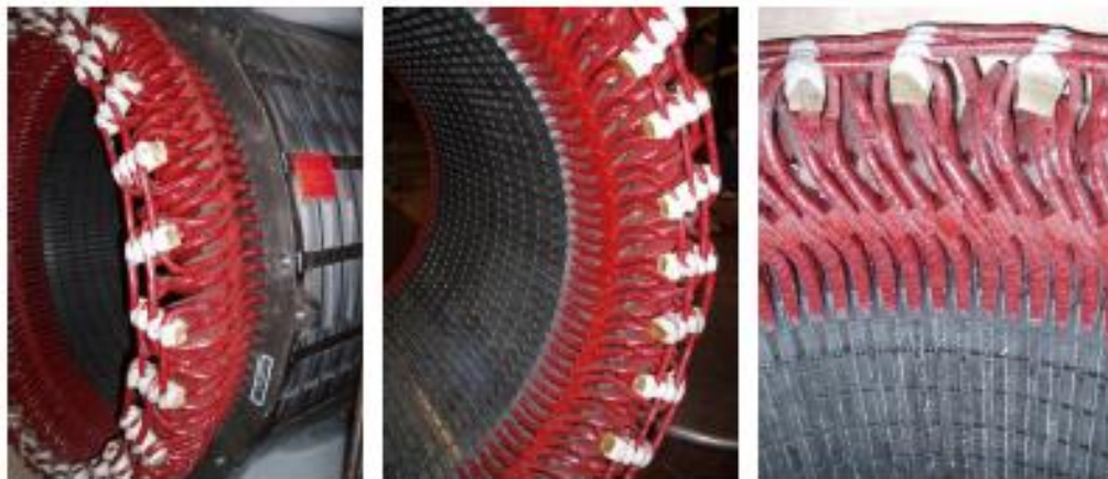
Figura 3.4 - Região das cabeças de bobinas interligadas.
