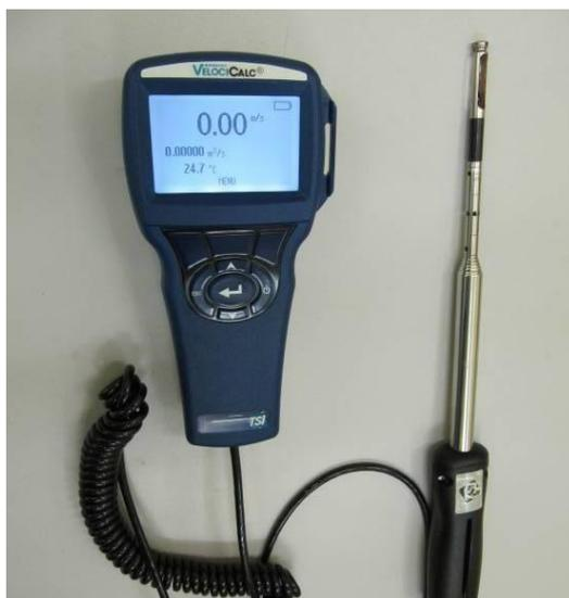
**Figura 3.29** – Anemômetro e sonda de medição.
