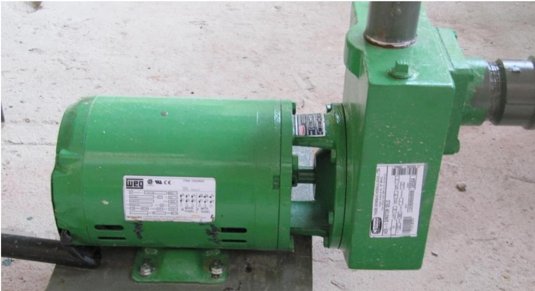
**Figura 3.22** – Bomba centrífuga autoescorvante adequada para recalque de lama.
