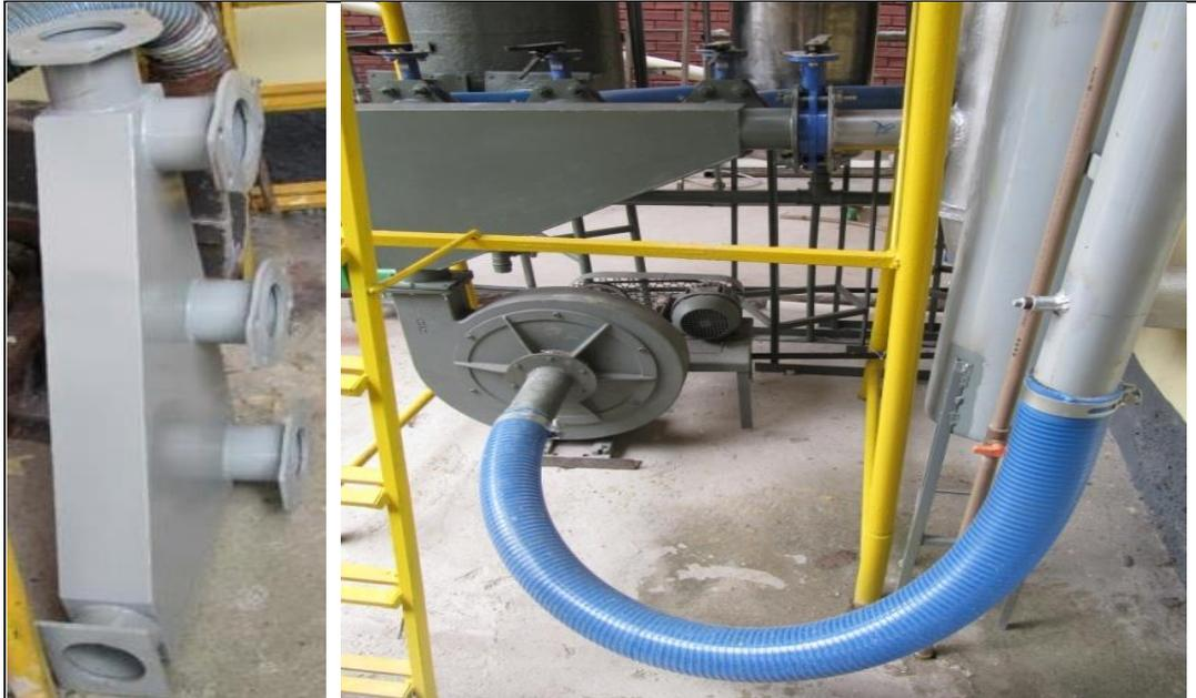
**Figura 3.14** – Conjunto de manuseio de gases, a direita o trocador de calor, ao centro o ventilador centrífugo e na parte superior o distribuidor de gases com as válvulas.
