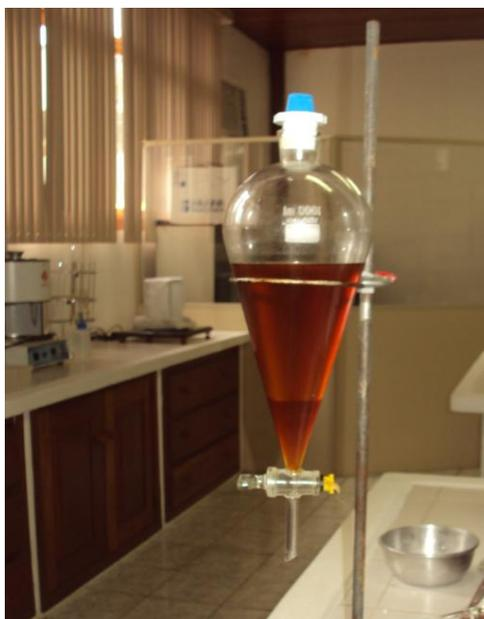
Figura 3.14 Separação e lavagem do biodiesel
