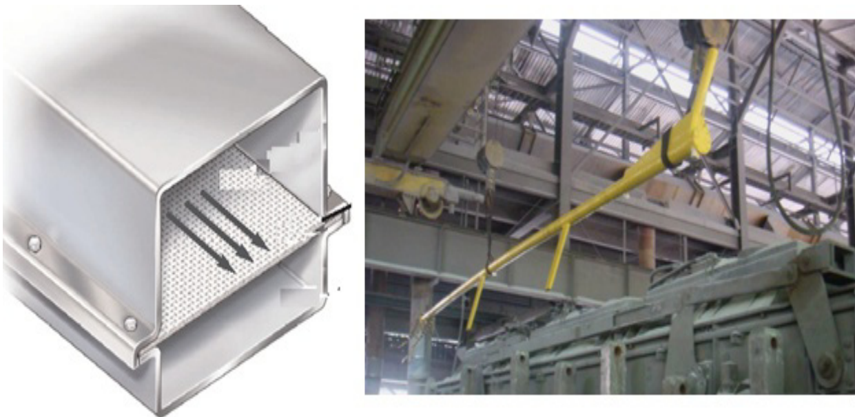
Figura 4.25 – Transportador pneumático fluidizado com três saídas e a esquerda “airslide” convencional – fonte: Albras.
