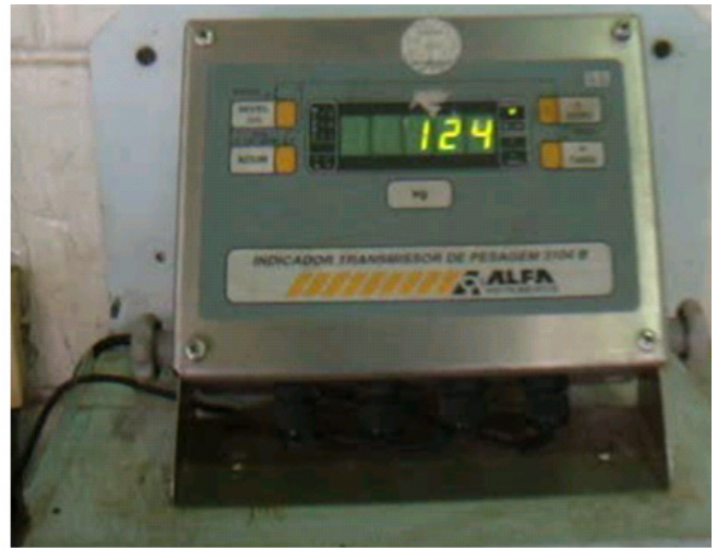
Figura 4.34 – Medição da vazão mássica ar - alumina fluoretada no escoamento no transportador pneumático fluidizado no intervalo de 1 minuto; a) tambor de 200 L.
