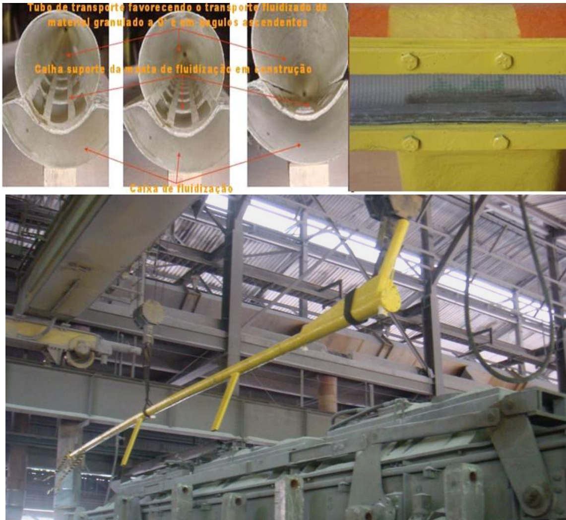
Figura 3.18 - Detalhes de tubo fluidizado construído em fibra de vidro com possibilidade de múltiplas descargas.
