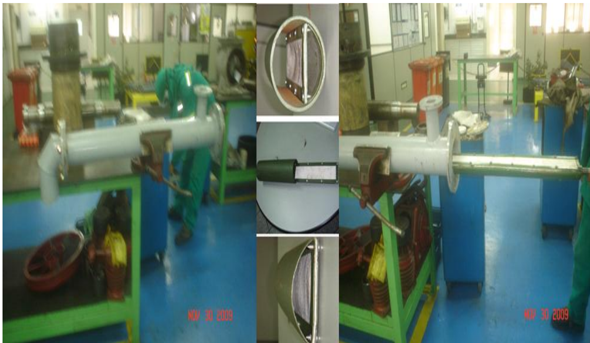
Figura 3.15 - Tubo metálico com calha de fluidização extraível.
