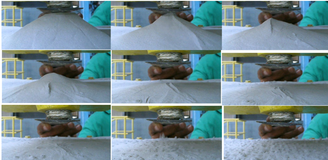
Figura 4.17 – Sequência de fotos do decaimento do ângulo de repouso aerado da alumina fluoretada usada no processo produtivo da Albras.
