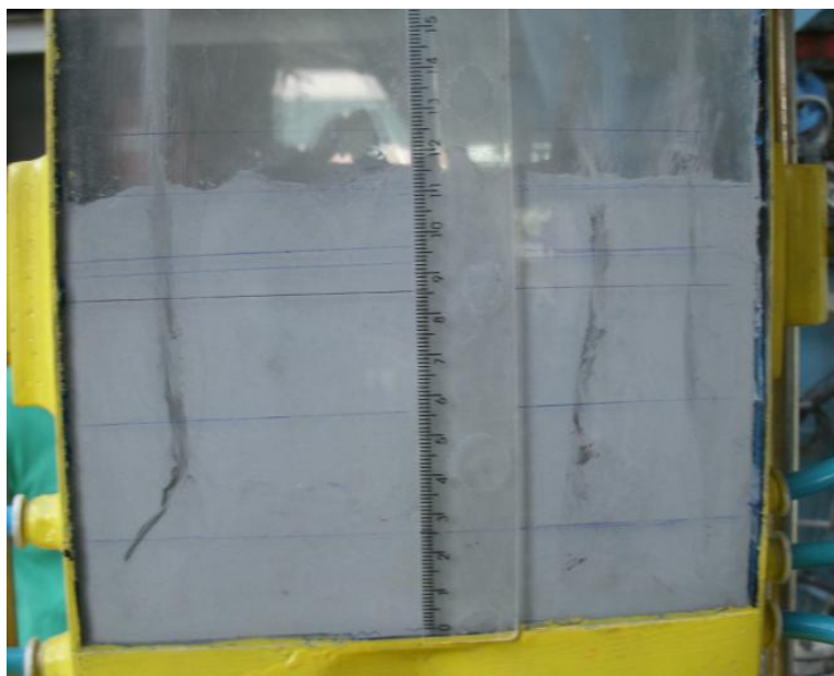
Figura 4.7 – Permeâmetro retangular de 50x200mm usado no teste de fluidização da alumina fluoretada sub 37 \mu m (GELDART (1973) grupo C).
