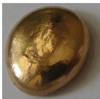
Figura 4.2 – Lingote Au-Cu no estado bruto de fusão e polido.
