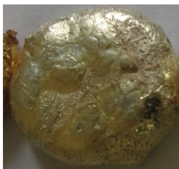
Figura 4.8 – Lingote Au-Cu-Ag no estado bruto de fusão.
