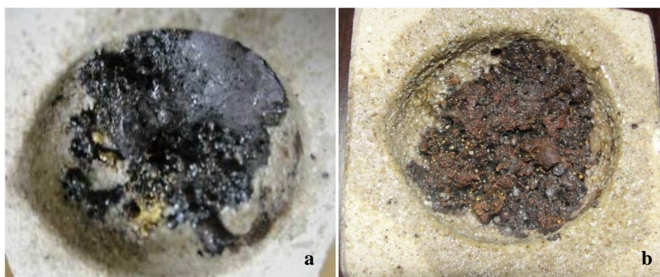
Figura 4.3 – Matéria prima submetida à temperatura de 1065^{\circ}C (a), por 20 minutos, e de 1071^{\circ}C (b), por 30 minutos..
