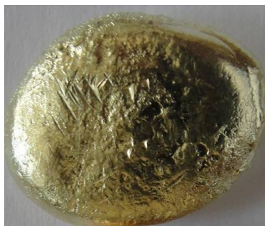
Figura 4.1 – Lingote Au-Ag em seu estado bruto de fusão.
