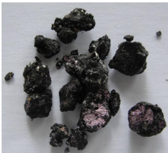
Figura 4.4 – Material fundido sob ação direta de calor em cadinho de cerâmica.
