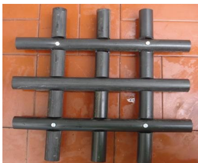
Figura 3.32: Estrutura taipal parafusada. Foto do autor(2013).
