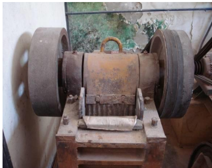
Figuras 3.21 e 3.22: Britadeira de mandíbula e rejeitos embalados prontos para britagem. Fotos do autor (2012).
