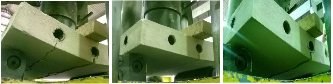
Figuras 4.19 a 4.21: Ensaio de flexão simples das placas 4, 5 e 6. Fotos: Bianca Barbosa (2014).
