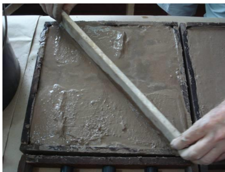
Figura 3.33: Desempeno das Placas. Foto: Dinah Tutuya (2013).
