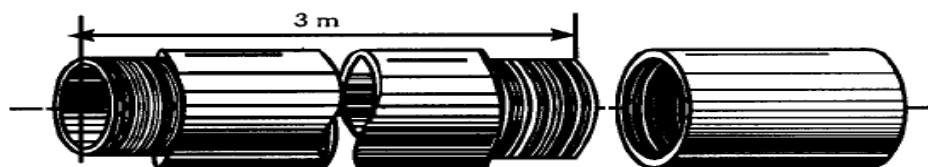
Figura 3.7: Detalhe do eletroduto rígido de PVC. Fonte: LIMA FILHO(2001).
