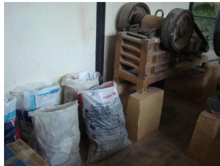
Figuras 3.21 e 3.22: Britadeira de mandíbula e rejeitos embalados prontos para britagem. Fotos do autor (2012).
