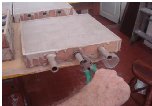
Figura 3.44: Retirada dos pinos.Foto: Cybelle Miranda (2014).
