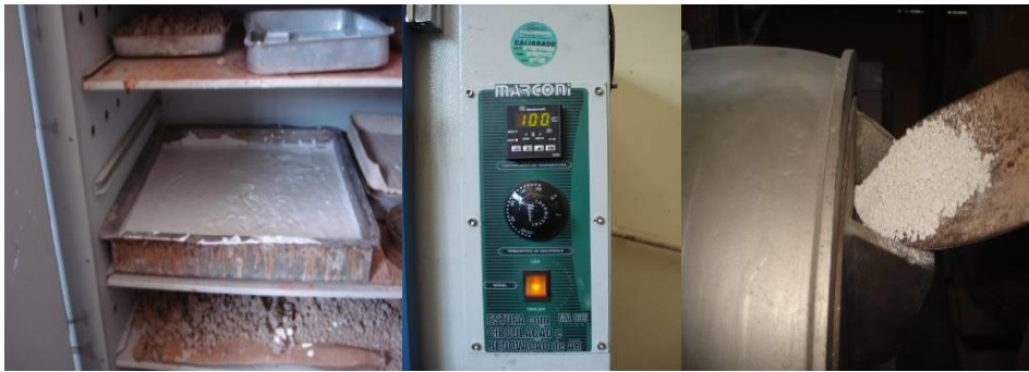
Figuras 3.28 a 3.29: Processo de secagem e moagem da cal hidratada. Fotos do Autor (2012).
