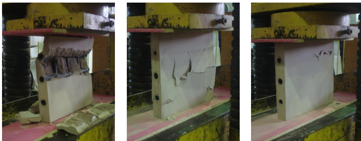
Figuras 4.16 a 4.18: Ensaio de compressão das placas 1, 2 e 3. Fotos: Ruan Lopes(2014).
