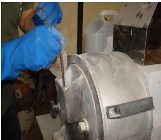
Figuras 3.24 e 3.25: Material da 1º peneiragem sendo moído e peneirado em malha #65. Fotos do Autor(2012).
