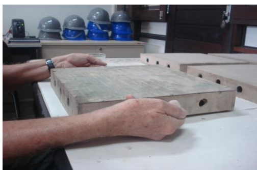
Figura 3.47: Início da retirada da forma. Foto: Amanda Farias (2014).
