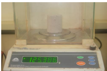
Figura 4.1: Pesagem dos corpos secos. Foto: Amanda Farias(2014).
