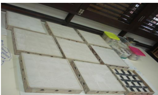
Figura 3.45: Placas prontas para desforma.Foto do autor (2014).
