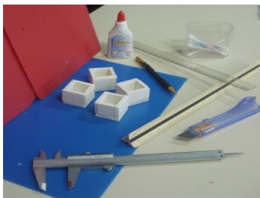
Figura 3.4: Material necessário para confecção das formas. Foto do autor(2014).
