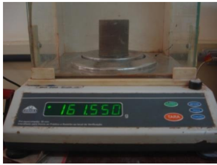
Figura 4.3: Verificação de massa do corpo úmido. Foto: Amanda Farias(2014).
