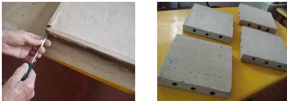
Figuras 4.9 e 4.10: Desforma das primeiras placas fundidas e placas desformadas. Foto: Cybelle Miranda (2013).
