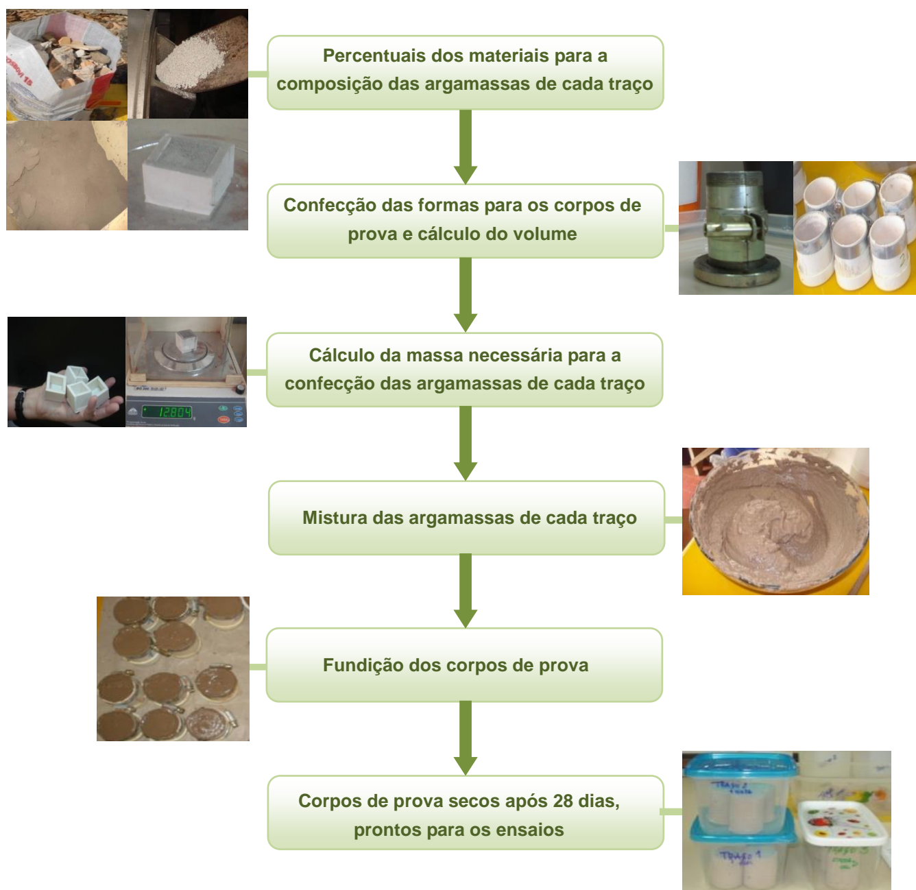
Figura 3.3: Fluxograma do delineamento experimental. Desenho concebido pelo autor (2014).
