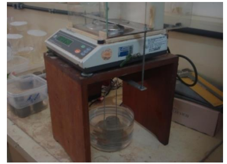
Figura 4.4: Verificação do corpo imerso. Foto: Amanda Farias(2014).
