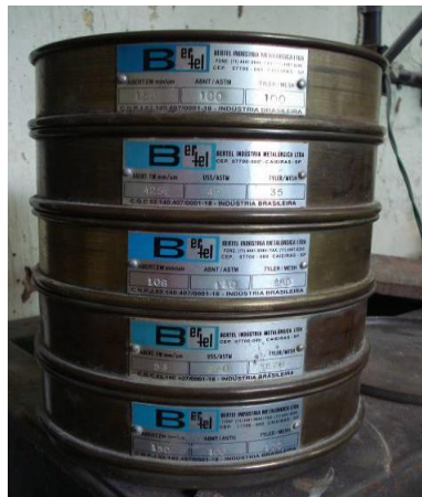
Figuras 3.24 e 3.25: Material da 1º peneiragem sendo moído e peneirado em malha #65. Fotos do Autor(2012).
