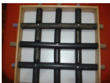
Figura 3.39: Parafusamento dos dutos. Foto do autor, fevereiro(2014).
