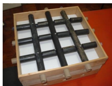
Figura 3.40: Fixação da estrutura na fôrma e distância às superfícies da placa. Foto do autor, fevereiro(2014).
