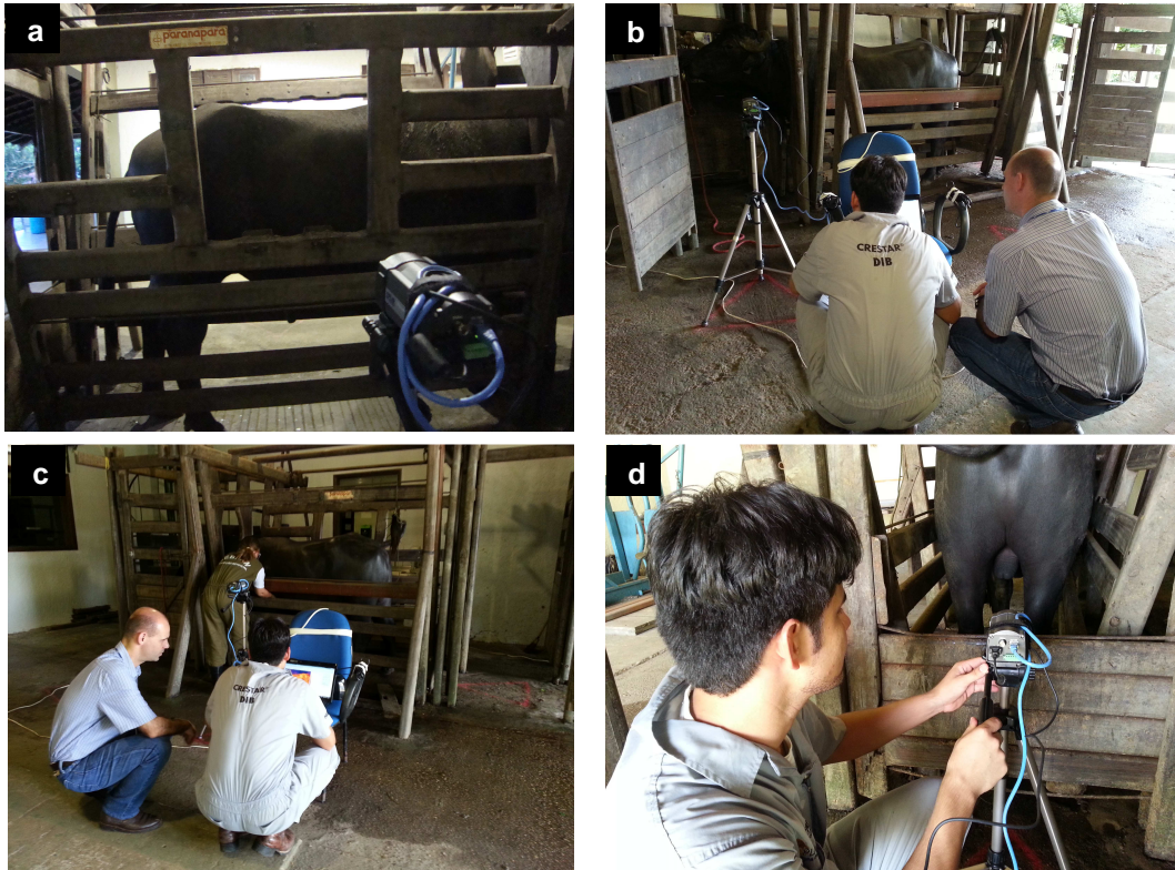
Figura 3 – a) Captura de imagens infravermelhas da região do flanco direito (FLd), b) captura de imagens infravermelhas da região do globo ocular (GLO), c) captura de imagens infravermelhas da região do flanco esquerdo (FLe), d) captura de imagens infravermelhas da região do escroto (ESC).
