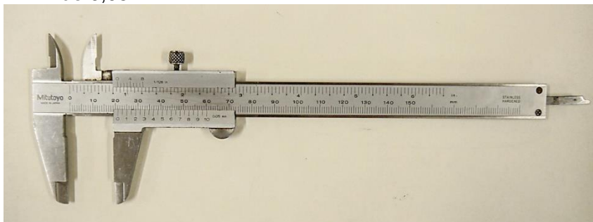
Fotografia A1 - Paquímetro de aço, marca Mitutoyo, com precisão de 0,05 mm
