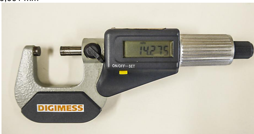
Fotografia A2 - Micrômetro digital de aço, marca Digimess, com precisão de 0,001 mm
