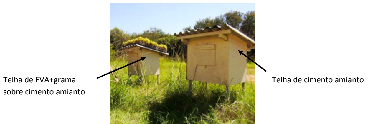
Figura 42: Protótipos telha EVA+grama+cimento amianto & cimento amianto Fonte: Bayer, 2006.
