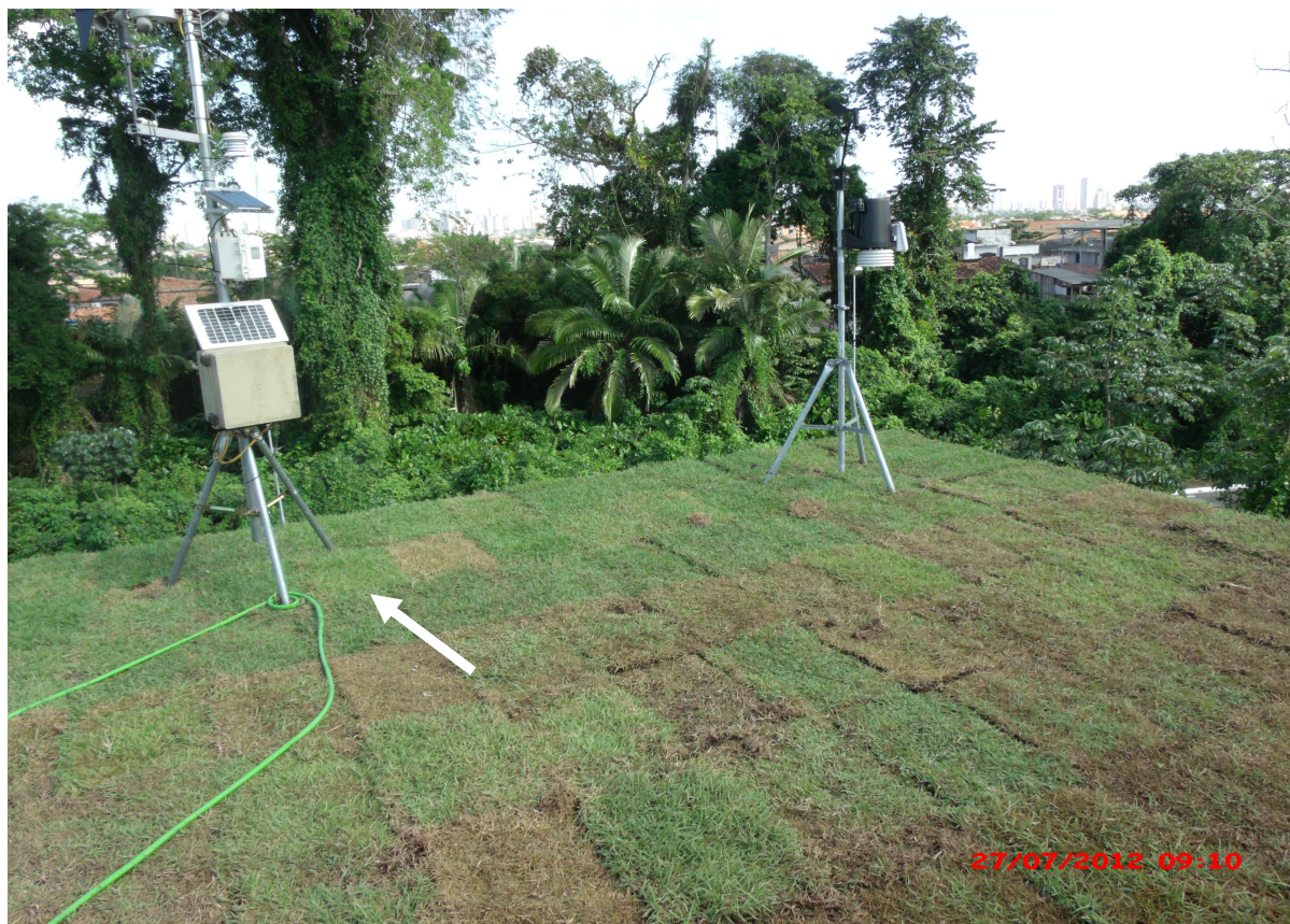
Figura 54: Estação climatológica LABCONF/CEAMAZON sobre o telhado vegetal.
