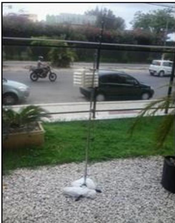
A Figura 36: Foto Abrigo para sensor HOBO utilizado nos experimentos de Campo, modelo com tripé.
