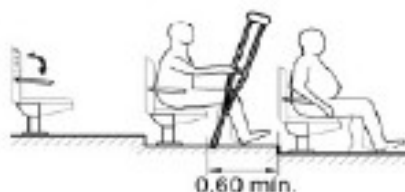
Espaço frontal para pessoas com mobilidade reduzida Fonte: NBR 9050 ABNT
