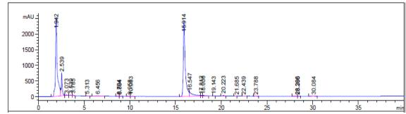
Figura 21 – Cromatograma de FLMEOH de flor registrado a 200 nm por HPLC-UV-ELSD
