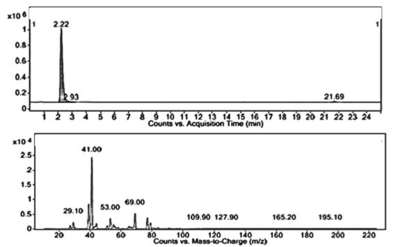
Figura 34 –TIC referente ao m/z 222 com espectro de fragmentação de FOCM obtidos por UHPLC-DAD-ESI-MS em modo positivo, Product Ion.
