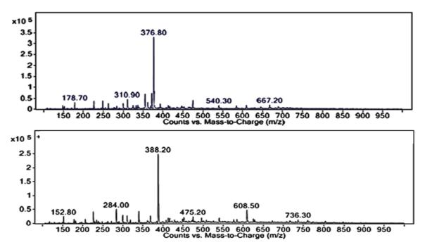
Figura 38- Espectros de massa obtidos por UHPLC-DAD-ESI-MS no modo positivo, Scan de FOCAE.
