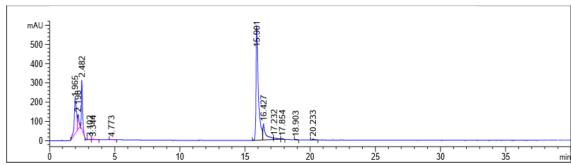
Figura 18 - Cromatograma de EEAOFL registrado a 275 nm por HPLC-UV-ELSD.
