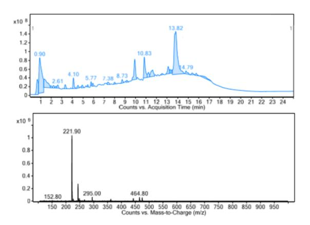
Figura 33- Cromatograma de íons totais e espectro de massas de RM obtidos por UHPLC-DAD-ESI-MS em modo gradiente com 50 % etanol e 50% de água por 1 minuto, 1 a 11 minutos 50% a 95% de etanol, 11 a 15 minutos 95% de etanol e 5% de agua, 15 a 20 minutos 95% a 50% de etanol, 20 a 25 minutos 50 % de etanol e 50% de água, fluxo 0,4 mL/min
