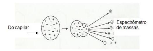
Figura 5 – Formação de íons em Eletrospray Fonte: Hesse, 2008.
