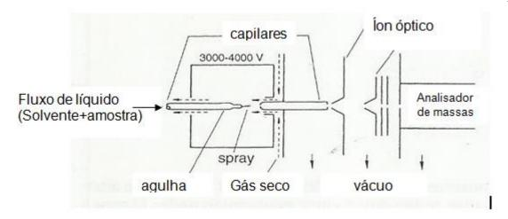
Figura 4 -Representação esquemática da fonte de ionização por nebulização eletrônica Fonte: HESSE, 2008
