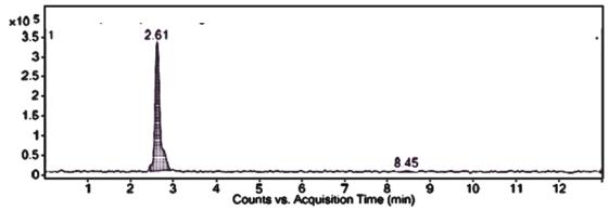
Figura 30 – Cromatograma de Íon Extraído (EIC em inglês) de FL20, modo isocrático 60 % acetonitrila 40% água, fluxo 0,05 mL/min.
