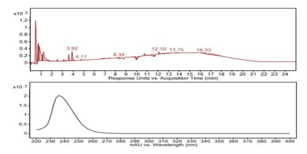
Figura 32- Cromatograma em 260 nm e espectro no ultravioleta de FOCM obtidos por UHPLC-DAD-ESI-MS em modo gradiente com 50 % etanol e 50% de água por 1 minuto, 1 a 11 minutos 50% a 95% de etanol, 11 a 15 minutos 95% de etanol e 5% de agua, 15 a 20 minutos 95% a 50% de etanol, 20 a 25 minutos 50 % de etanol e 50% de água, fluxo 0,4 mL/min.
