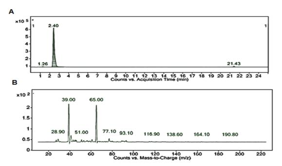
Figura 36 – TIC referente ao m/z 222 com espectro de fragmentação de RM, obtidos por UHPLC-DAD-ESI-MS em modo positivo, ESI Product Ion.
