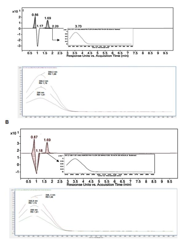
Figura 27 – Cromatogramas de FL20 registrados em UHPLC-DAD a 250 nm (A) e 260 nm (B) em modo isocrático 70:30 (ACN/água pH 3 ácido fórmico), fluxo 0,150 mL/min.
