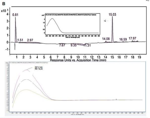
Figura 25 – Cromatogramas de FL20 registrados por UHPLC-DAD a 250 nm (A) e 260 nm (B) em modo gradiente linear 98% de água a pH 3 (ácido fórmico) a 98% de ACN ,fluxo 0,150 mL/min.
