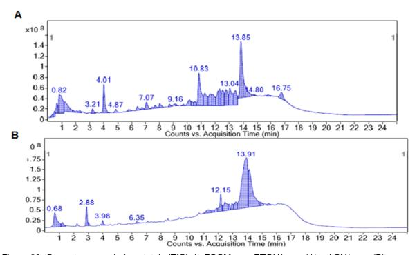
Figura 39- Cromatograma de íons totais (TIC) de FOCM com ETOH/agua (A) e ACN/agua (B)
