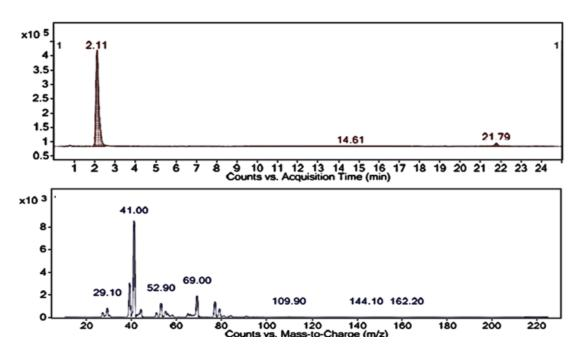
Figura 35 – TIC referente ao m/z 222 com espectro de fragmentação de FOCM, obtidos por UHPLC-DAD-ESI-MS em modo positivo, Product Ion.
