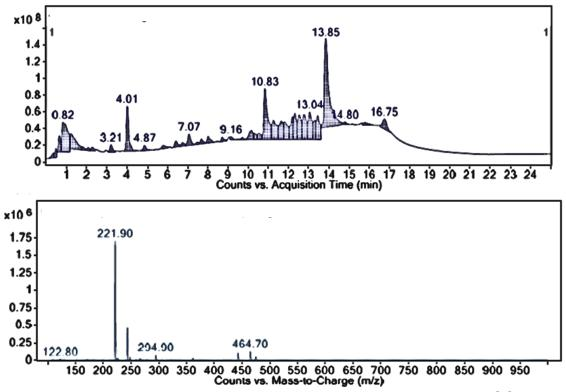
Figura 31- Cromatograma de íons totais (TIC em inglês) e espectro de massas de FOCM obtidos em modo positivo, Scan, por UHPLC-DAD-ESI-MS.
