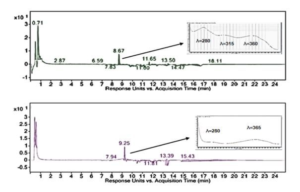
Figura 37- Cromatogramas de FOCAE obtidos por UHPLC-DAD-ESI-MS em 365 nm para Fase móvel etoh/agua e ACN/agua, respectivamente.
