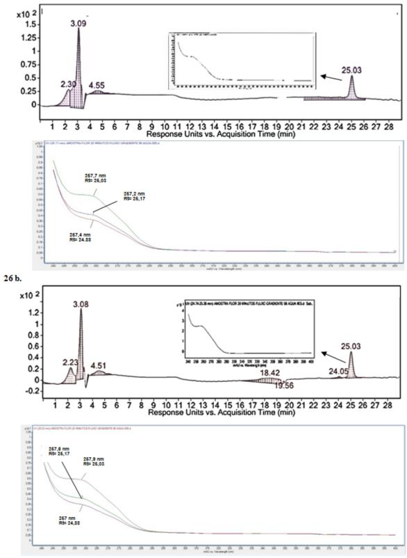
Figura 26 – Cromatogramas de FL20 registrados por UHPLC-DAD a 250 (26a) e 260 nm (26b) em modo gradiente linear 98% de agua a pH 3 (ácido fórmico) a 98% de ACN com fluxo 0,05 mL/min.
