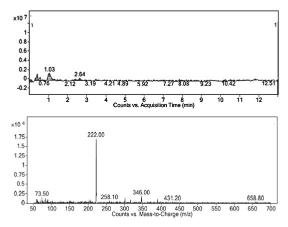
Figura 29-Cromatograma de íons totais de FL20 (TIC em inglês) e espectro de massas obtido em modo Scan por UHPLC-DAD-ESI-MS.
