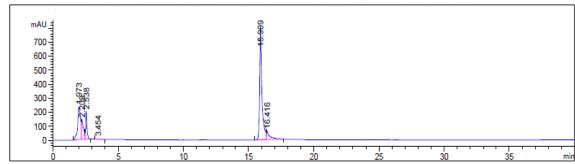
Figura 23 - Cromatograma de FLMEOH registrado a 275 nm por HPLC-UV-ELSD
