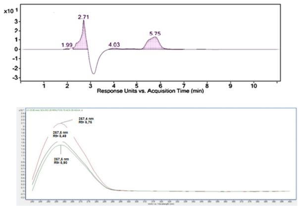
Figura 28- Cromatograma de FL20 registrado em UHPLC-DAD a 270 nm em modo isocrático 70:30 (ACN/água pH 3 ácido fórmico), fluxo 0,05 mL/min.
