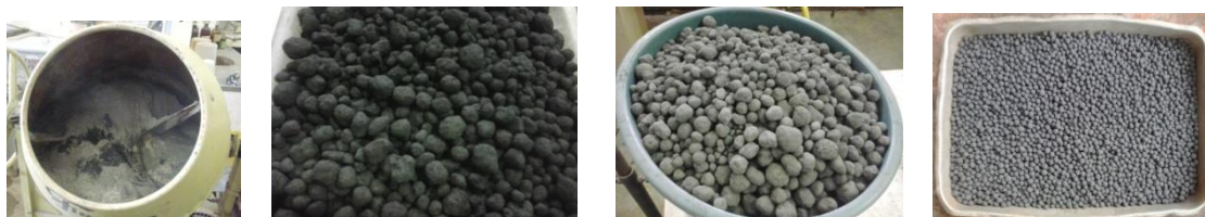
Figura 3.4 - (a) Betoneira; (b) Pelotas úmidas; (c), (d) Pelotas secas com diferentes granulometrias.
