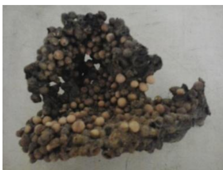
Figura 4.8 - Aspecto das pelotas após sofrer o processo de sinterização durante a reação de combustão.
