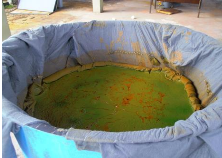
Figura 3.8: Lodo desaguado na UDL para retirada e caracterização.
