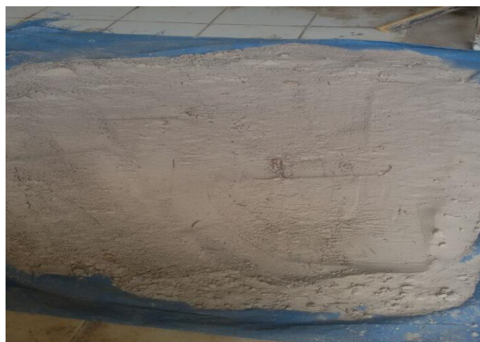
Figura 3.16: Agregado miúdo natural (areia) em processo de pré-secagem.
