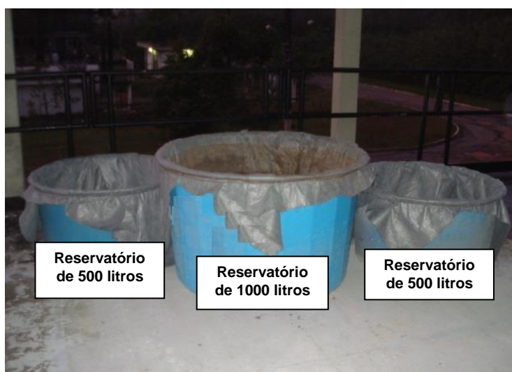
Figura 3.5: Parte do conjunto da UDL montada ao lado dos decantadores.
