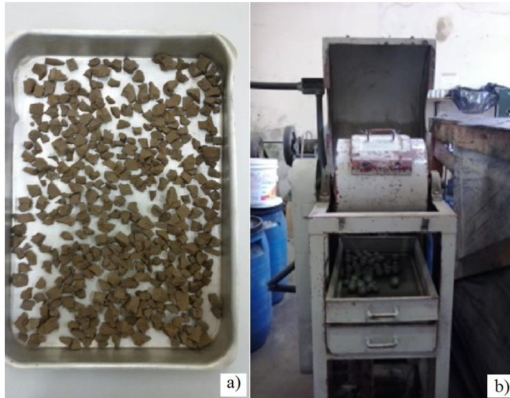
Figura 3.11: a) Lodo seco da ETA Bolonha após secagem em estufa a 105 °C; b) Moinho de bolas para desagregação do lodo seco.
