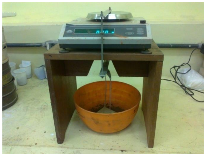
Figura 3.19 Aparato para obtenção da massa imersa dos agregados.
