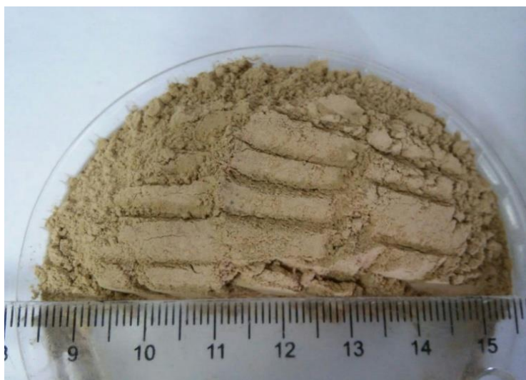
Figura 3.14: Argila beneficiada após secagem em estufa e moagem em moinho de bolas.
