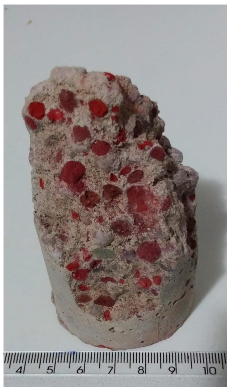
Figura 4.17: Corpo-de-prova (CAS) rompido com 28 dias.
