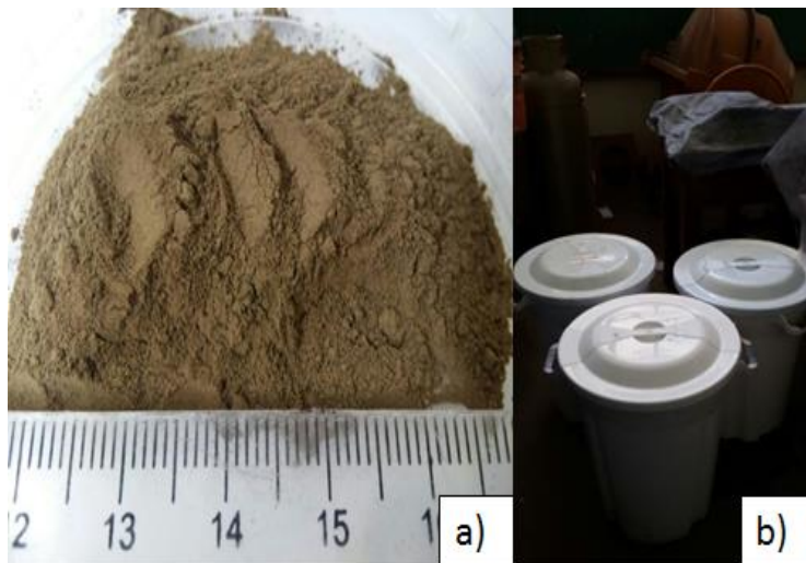
Figura 3.12: a) Lodo após processamento pelo moinho de bolas; b) Acondicionamento em recipientes plásticos do lodo.
