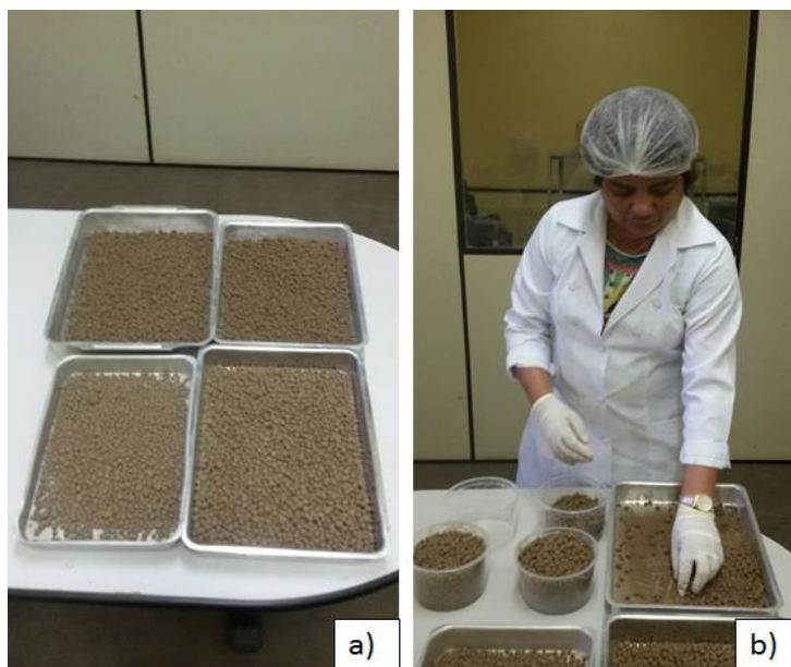
Figura 3.23: a) agregados após secagem em estufa; b) armazenamento dos agregados. Fonte: Autora, 2016
