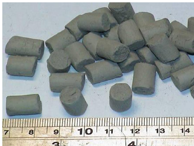
Figura 2.10: Lodo de ETA após peletização em extrusora
