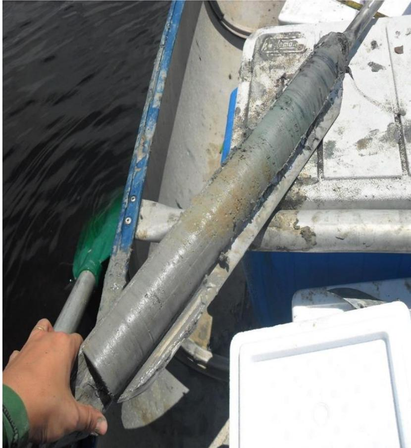
Figura 6 – Testemunho no momento da coleta, posteriormente acomodado em cano pvc e resfriado a 4°C.
