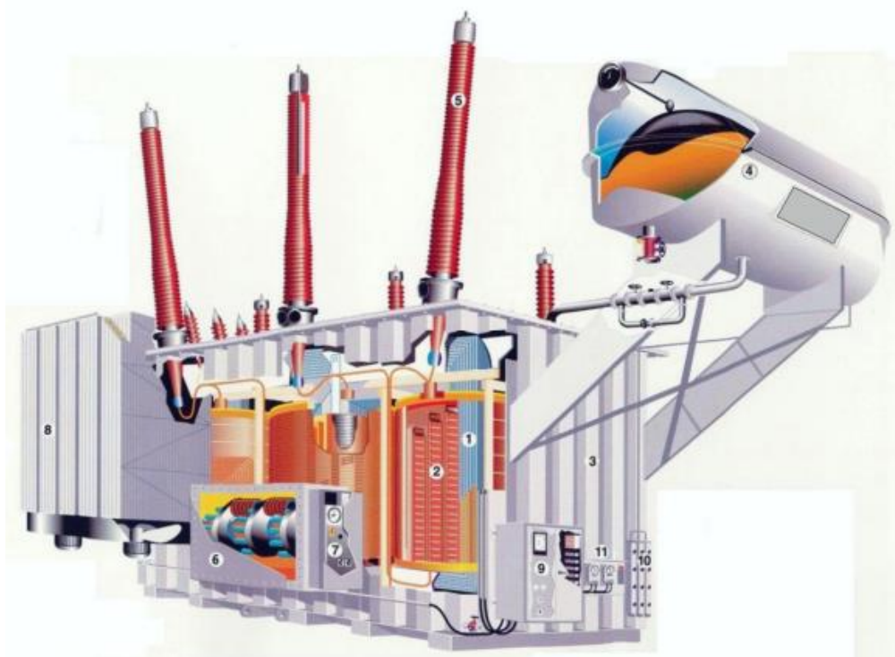
Figura 1 - Características construtivas de um transformador de potência.
