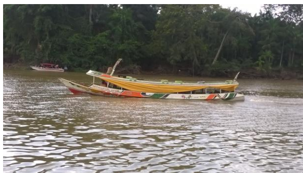
Fotografia 25 – Rabetão com propulsão a motor de 90 a 400 HP navegando pelos rios de Igarapé-Miri.
