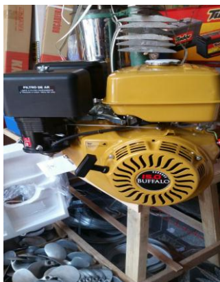
Fotografia 23 – Motor estacionário movido à gasolina, marca Buffalo de 15 HP de potência.
