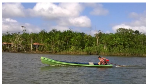
Fotografia 22 – Rabeta com propulsão a motor estacionário de polpa navegando pelos rios de Igarapé-Miri.
