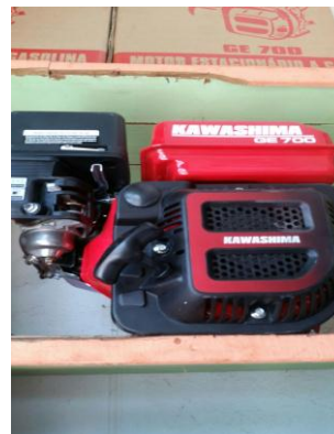
Fotografia 24 – Motor estacionário movido à gasolina, marca Kawashima de 7 HP de potência.
