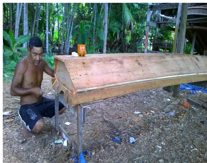
Fotografia 13 – Mestre Carlinho, do segmento carpinteiro naval, construindo uma rabeta.
