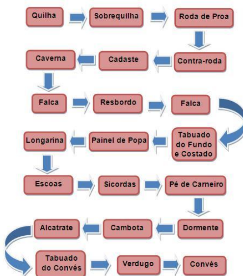
Fluxograma 1 – Sequência de montagem dos principais componentes de uma embarcação de madeira.
