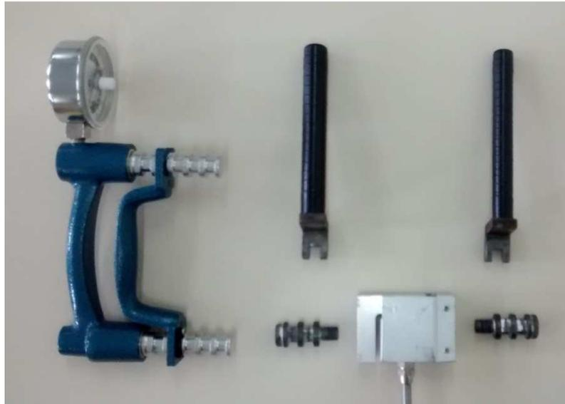
Figura 7. Dinamômetro JAMAR® (Azul) e peças (manetes em preto e parafusos) utilizadas para mimetizar suas dimensões adaptadas a célula de carga.
