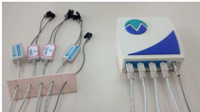
Figura 10. Eletromiógrafo utilizado para obtenção dos dados de força de preensão palmar.
