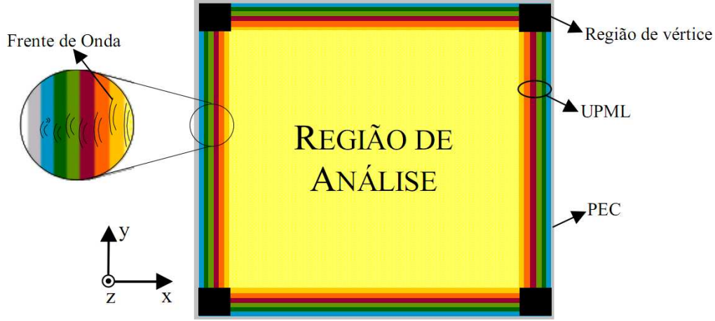
FIGURA 2.6: Esquema geométrico para truncagem espacial da malha usando a UPML em um plano [20].
