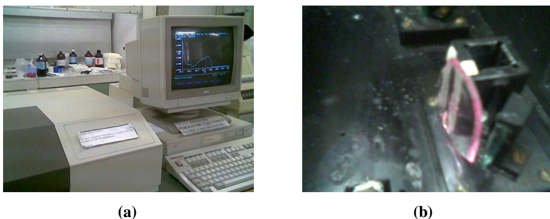
Figura 14 – Espectrofotômetro UV-vísivel (a) modelo Perkin Elmer Lambda 6 [central analítica DQF/UFPE], (b) amostra de filme APP/VM suportada no caminho óptico do aparelho, para caracterização do espectro de absorção UV-Visível. [by S.C.S. Costa].
