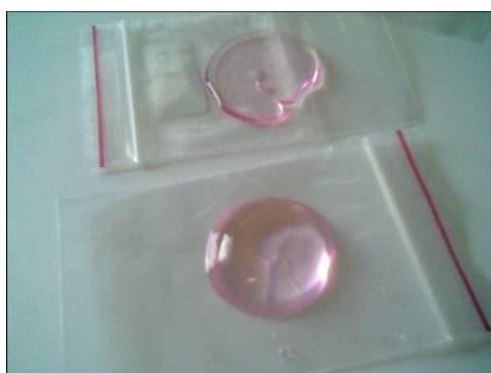
Figura 61 – Imagens do Gel APP/VM. Processo Sol-Gel de incorporação de compostos orgânicos.
