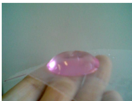
Figura 10 – Polifosfato de Alumínio APP/VM. Auto-sustentável, transparente observa-se presença de incorporação do composto orgânico [by S.C.S. Costa].
