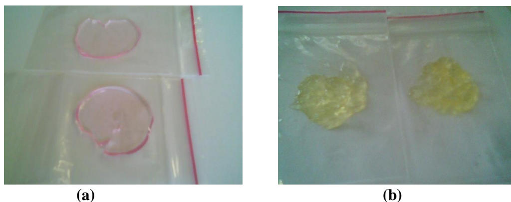
Figura 62 – Gel APP/VM sob atmosfera ácida e básica. (a) Filme de Gel APP/VM exposto à atmosfera de \text{NH}_3 (b) ocorrendo mudança na coloração do gel transparente vermelho para amarelo.
