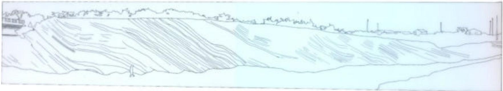
Seção panorâmica mostrando o aspecto geométrico da litofácies Pap da Formação Pacujá, constituída por bancos de arenitos finos/siltitos, de espessura centimétrica a métrica, contínuos lateralmente. Observar a inclinação e os dobramentos das camadas (afloramento localizado no sangradouro do açude Aires de Souza, na cidade de Jaibaras).
