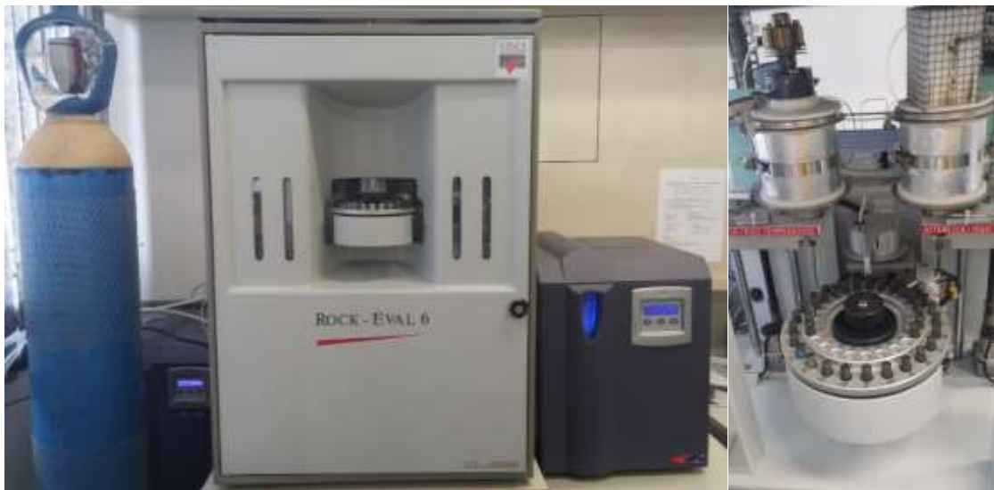
Figura 24 - Micro-forno Rock Eval 6 da marca Vinci LECO SC-632 para realizar o processo de pirólise no LGQM da UERJ.
