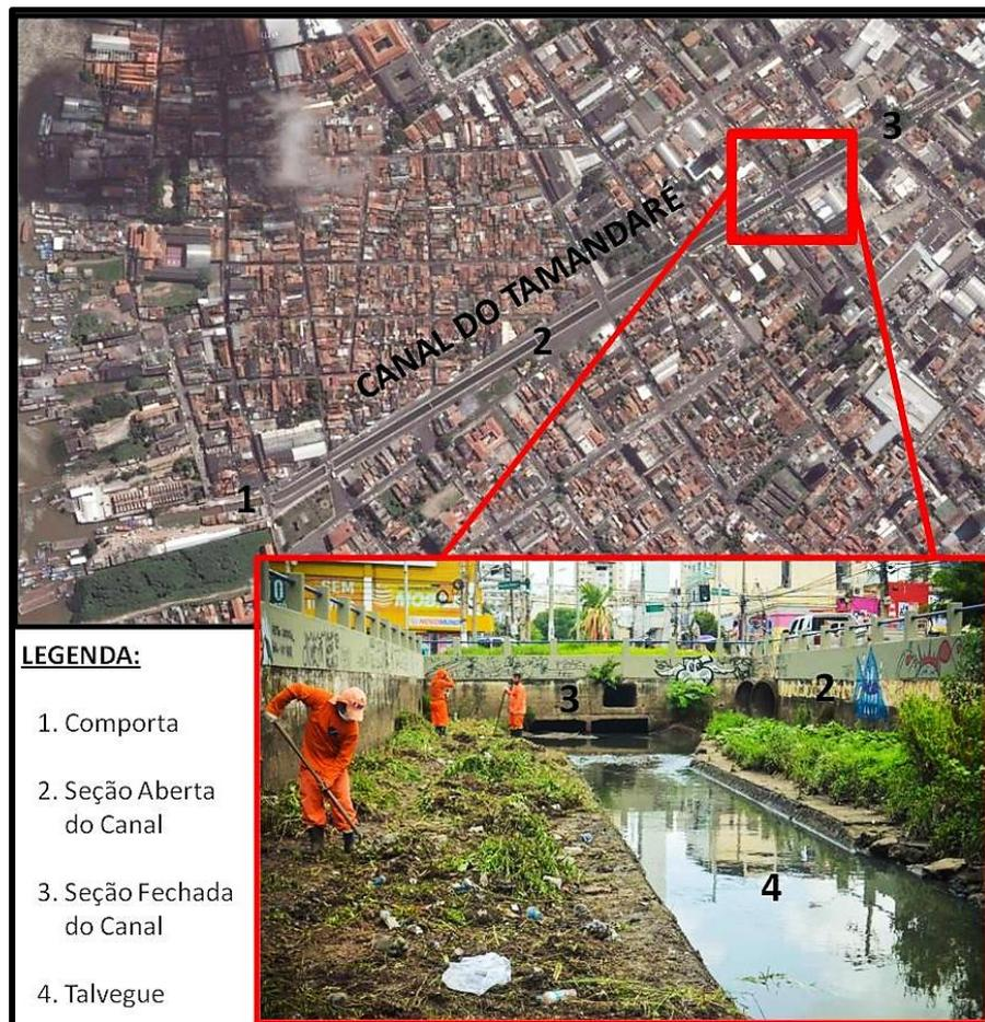
**Figura 4:** Tipos e componentes de uma obra de macrodrenagem.
