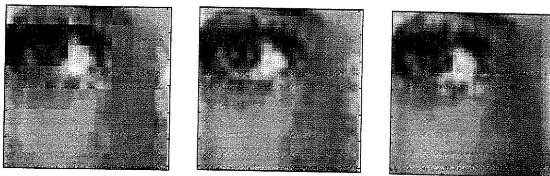
Figura 5.15. Detalhes das imagens codificadas com DCT, LOT e DSTr, com taxa de 0,2 bpp, quantizador gaussiano e alocação de bits adaptativa com 4 classes de energia.
