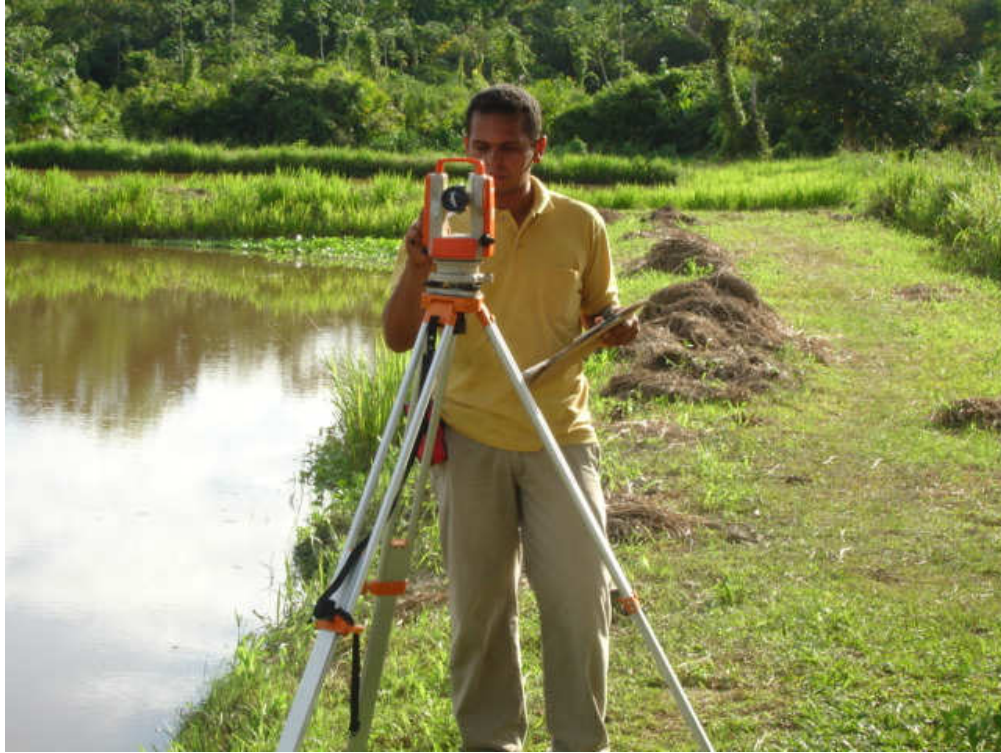
Figura 5: Topógrafo realizando levantamento plani-altimétrico com auxílio do teodolito.
