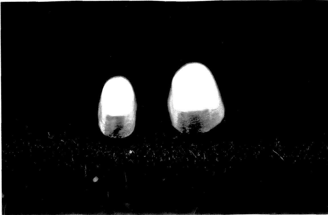
FIGURA 12 - Espaçadores metálicos de Cu-Al após acabamento e usinagem
