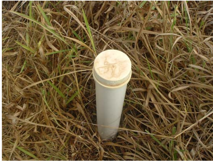
Figura 6: Foto de um dos poços de monitoramento.
