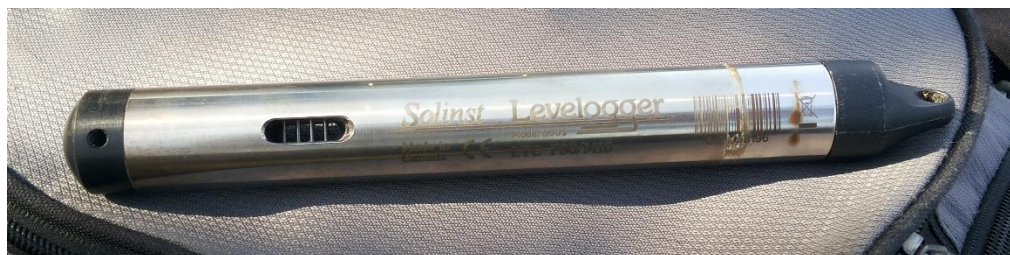
Figura 6 Sensor de pressão Solinst Levellogger Model 3001 com sensor de condutividade.
