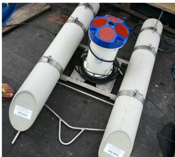
Figura 4 ADCP RIO Grande 600 kHz instalado em um catamarã.
