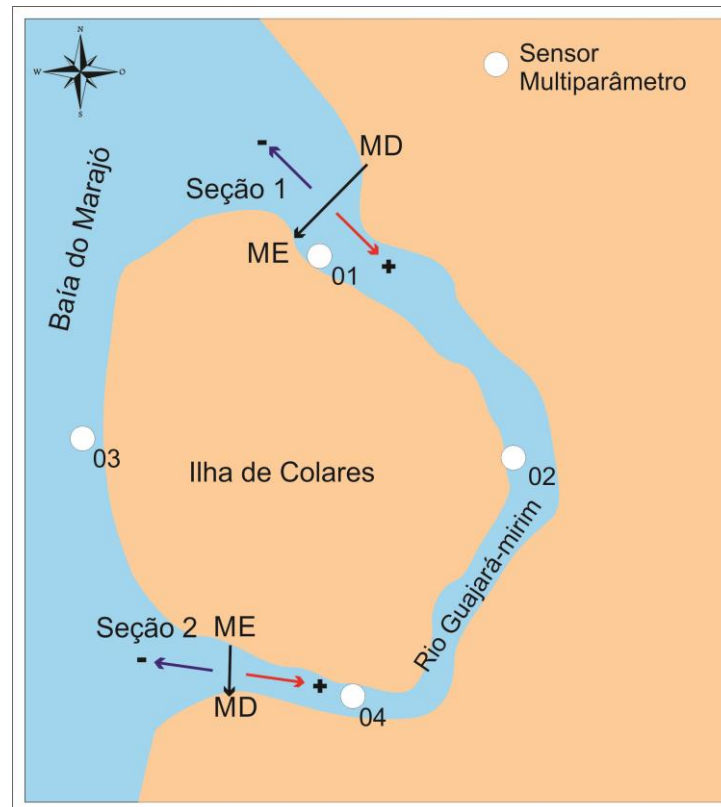
Figura 5 Croqui com a localização das seções, sentido convencional da componente transversal de velocidade e dos sensores multiparâmetro.
