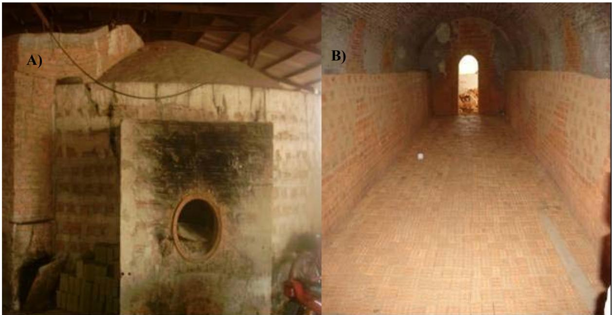
**Figura 5.11** – Fornos de Abóboda: A) Imagem externa do forno, B) Imagem interna do forno de abóboda.
