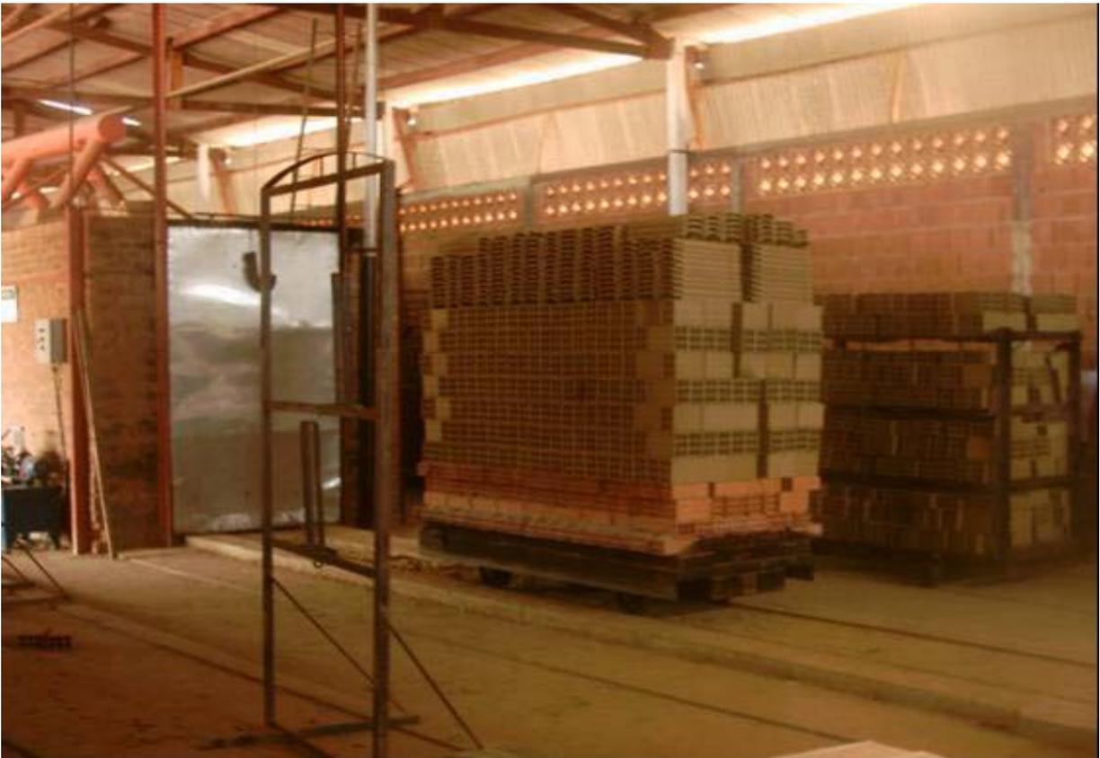
**Figura 5.12** – Vagoneta e entrada do forno de túnel.
