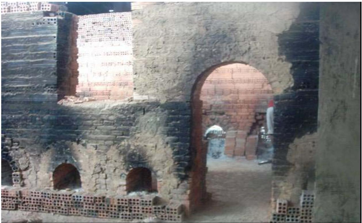
**Figura 5.10** – Forno tipo caieira da Cerâmica União.
