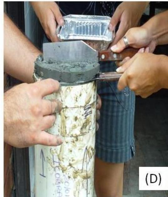
Figura 6- (A) Montagem de equipamento para fatiamento de testemunho; (B) Testemunho posicionado para fatiamento; (C) Fatiamento realizado com 2 cm de espessura e uma divisão ao meio da fatia; (D) Fatia de 2 cm de sedimento do testemunho.
