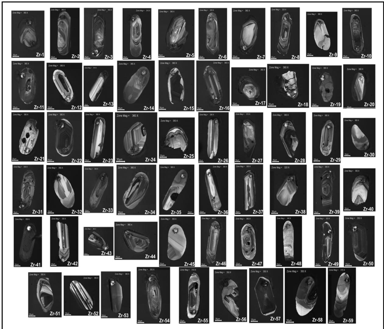
Figura 45 – Grãos de zircão detriticos extraídos da fácies At da Formação Nhamundá. Imagens feitas no Microscópio Eletrônico de Varredura (MEV) na Universidade Federal do Pará.
