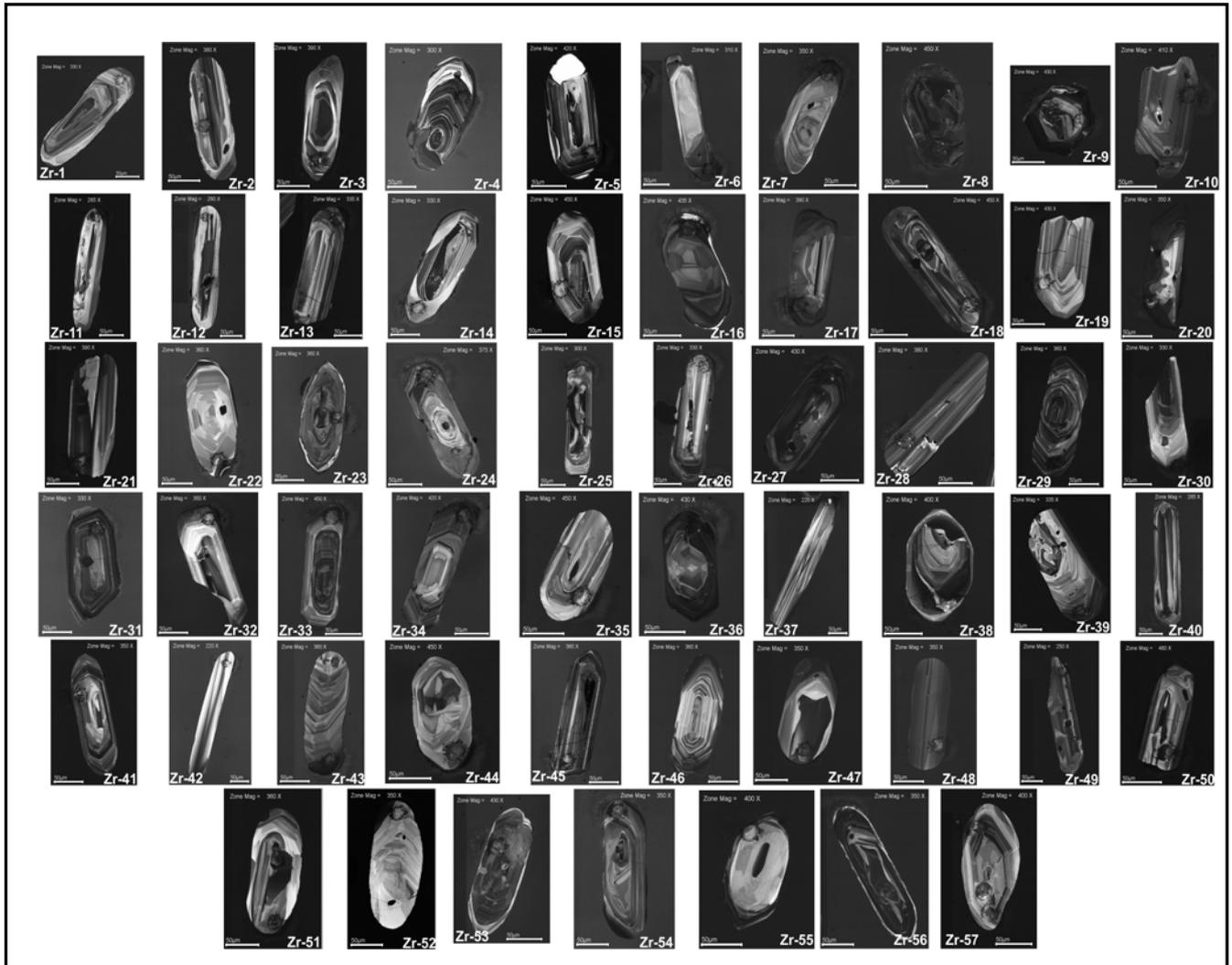
Figura 52 – Cristais de zircão detriticos extraídos da fácies Aca da Formação Manacapuru. Imagens feitas no Microscópio Eletrônico de Varredura (MEV) da Universidade Federal do Pará.
