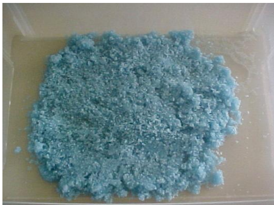
Figura 3.6 – Partículas de polipropileno com umidade
