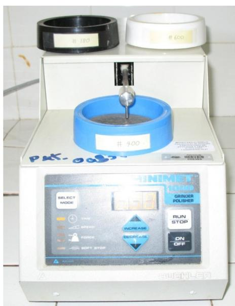
Figura 05. Aparelho utilizado para o polimento dos cortes dos otólitos.
