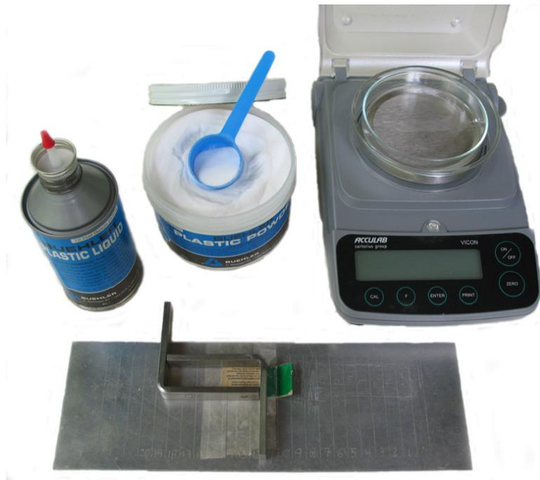
Figura 02. Balança, molde e resina utilizados para o embocamento dos otólitos.
