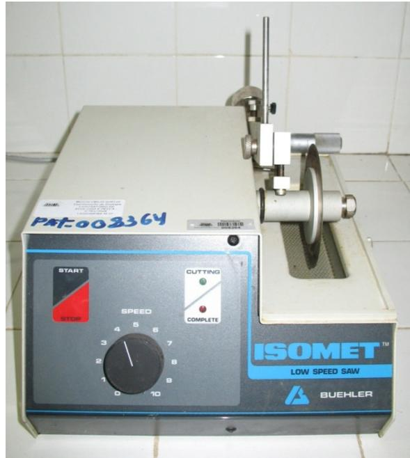
Figura 03. Micrótopo com serra de diamante (*Buehler Isomet*) utilizado para cortar os otólitos.
