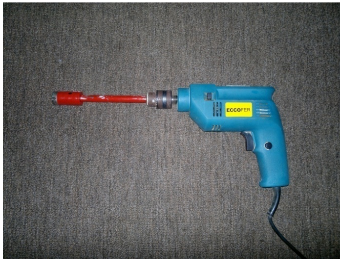
Figura 14: Perfuratriz portátil e broca diamantada utilizada para coleta de argamassas.
