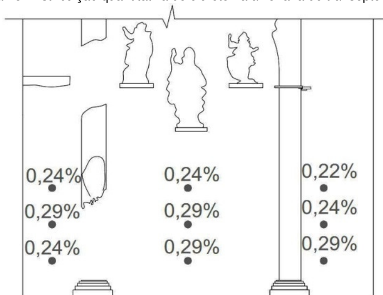
Figura 23: Distribuição quantitativa do cloreto na alvenaria do transepto direito.
