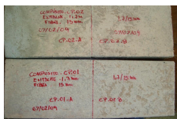
Compósito com entalhe 1,7 mm, comprimento da fibra 15,0 mm
