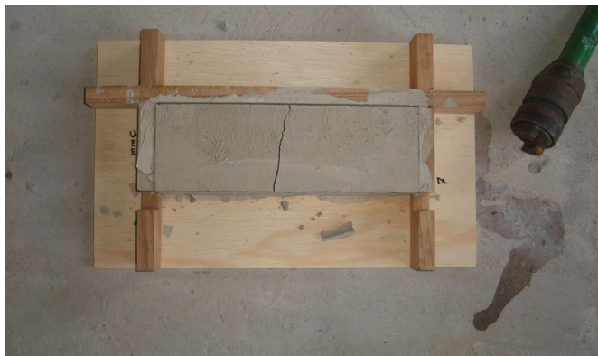
Figura 32 - Matriz com trinca na região mediana
