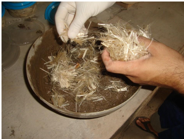
Figura 22- A fibra sendo adicionada a mistura da argamassa de cimento
