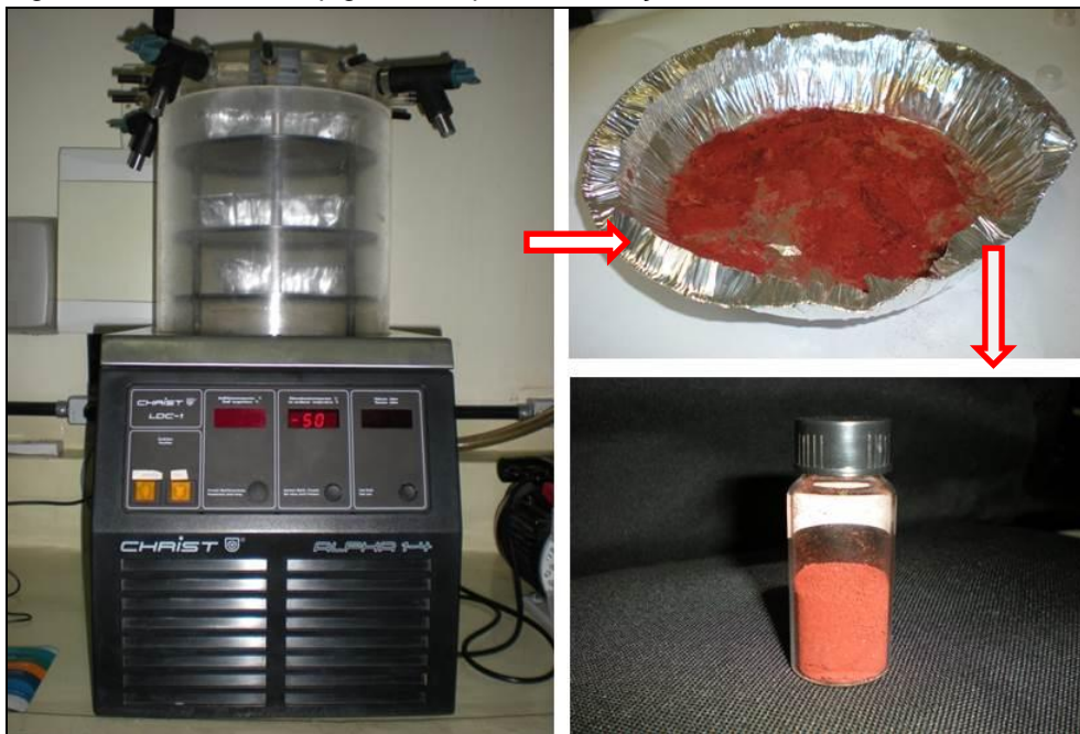
Figura 43: Liofilizador e pigmento, após a liofilização realizada no LEPRON/UFPA.
