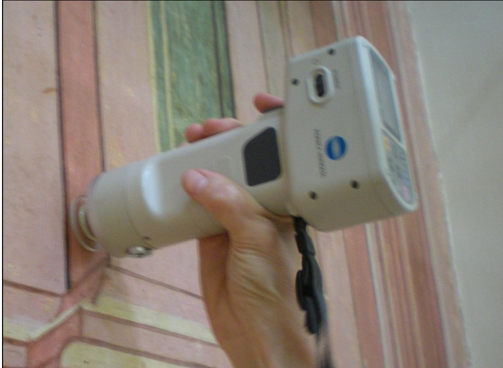
Figura 34: Procedimento realizado com o colorímetro para classificação das cores da pintura.
