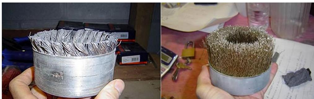
Figura 2.23 – Escovas de aço acopladas em lixadeira para limpeza do concreto.
