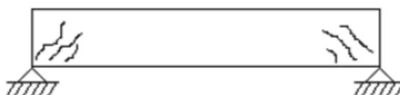
Figura 2.11 – Fissurações típicas em vigas solicitadas ao esforço cortante.
