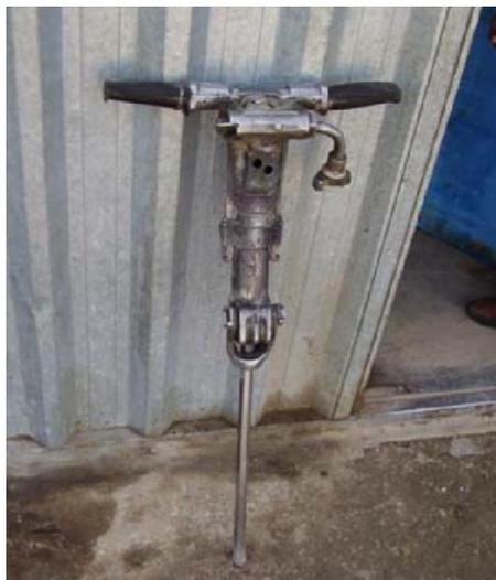
Figura 2.24 – Martelete pneumático
