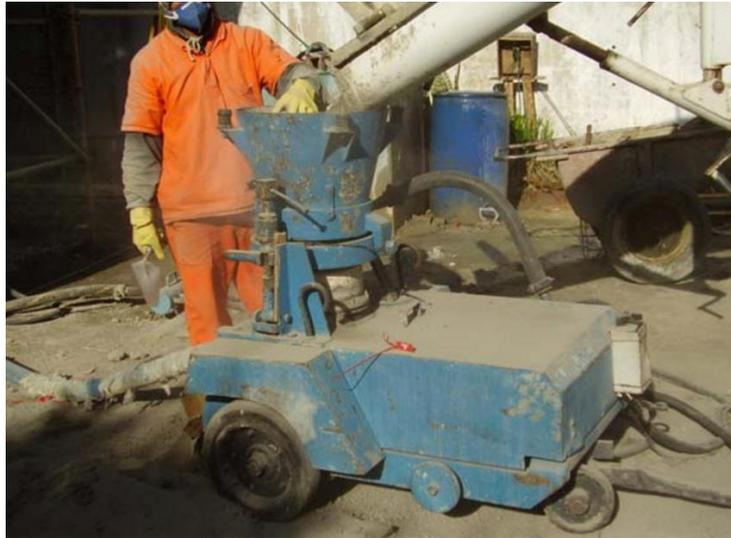
Figura 2.34 – Equipamento de mistura dos materiais
