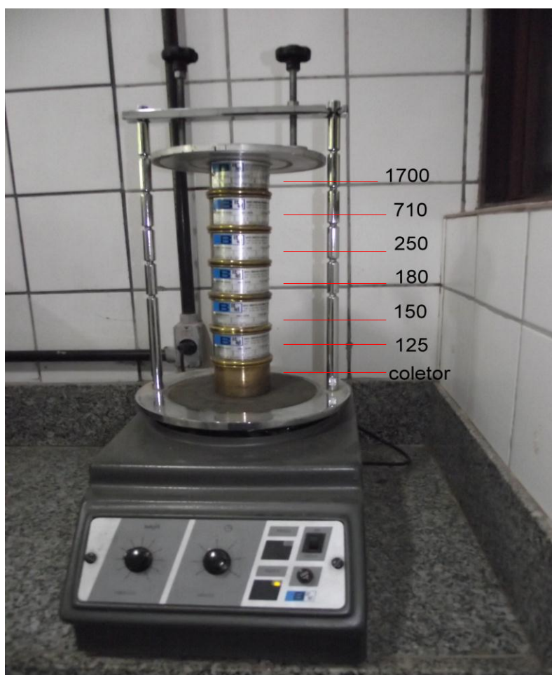
Figura 7 - Tamisador usado para análise granulométrica de Chrysobalanus icaco L. com indicação da posição do número de cada tamis em \mu\text{m} (micrômetros).
