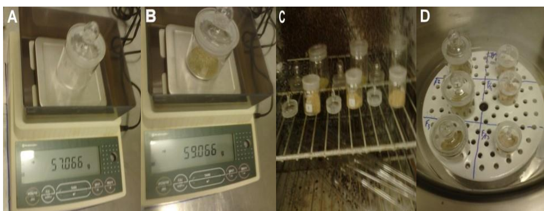
Figura 8 - Seqüência de passos da perda por dessecação pelo método de gravimetria. A: após dessecação dos pesa-filtros em estufa, obtenção do peso do pesa-filtro sem a amostra; B: pesagem do pesa-filtro com 2g do pó das folhas de C. icaco ; C: colocação dos pesa-filtros abertos com a amostra em estufa para dessecação; D: após retirada da estufa, armazenamento em dessecador para posterior pesagem.
