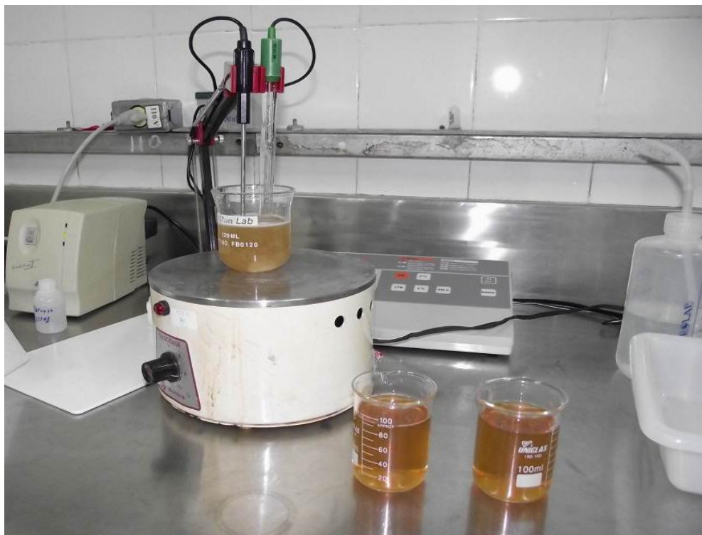
Figura 9 - Medição do pH de Chrysobalanus icaco L através de potenciômetro de bancada.
