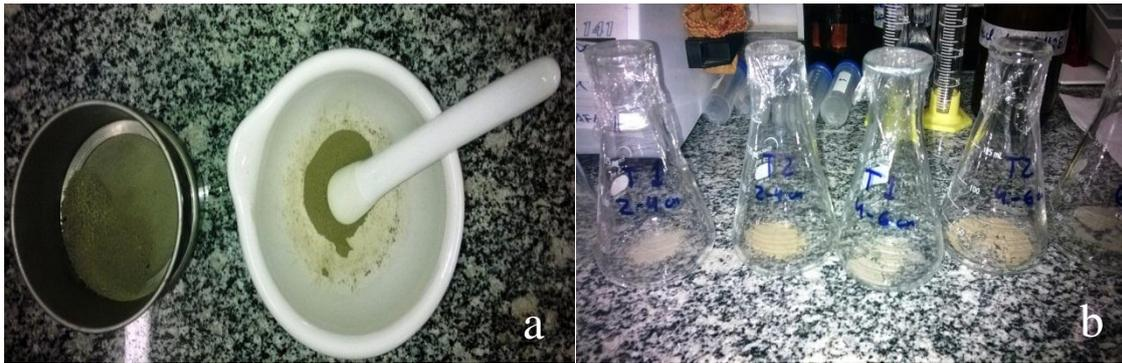
Figura 4 - Procedimento de peneiramento e homogeneização das amostras (a). Pesagem das amostras em erlenmeyers (b).
