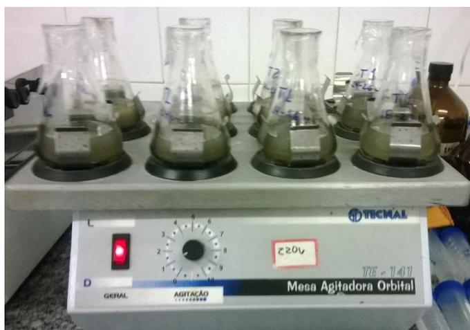
Figura 6 - Extração das frações de fósforo sedimentar sob agitação constante.
