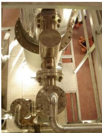
Figura 38 - Detalhe do primeiro estágio da filtragem do gás de síntese.
