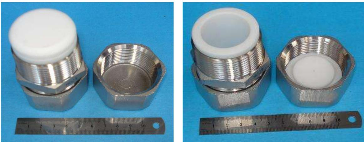
**Figura 9:** Autoclave utilizada no processo zeolítico.
