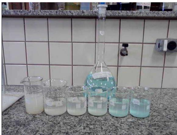
**Figura 13:** Ensaios de adsorção do íon de cobre na zeólita A em diferentes concentrações.
