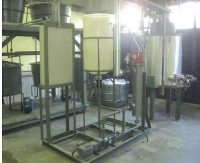
**Figura 4.24-** Sistema de Alimentação e Bombeamento da Unidade Piloto.
