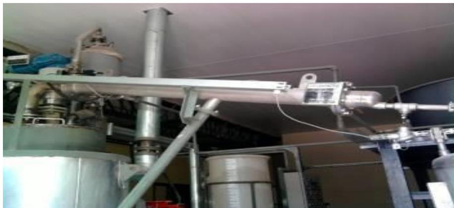
**Figura 4.29-** Condensador da Unidade Piloto de Craqueamento.
