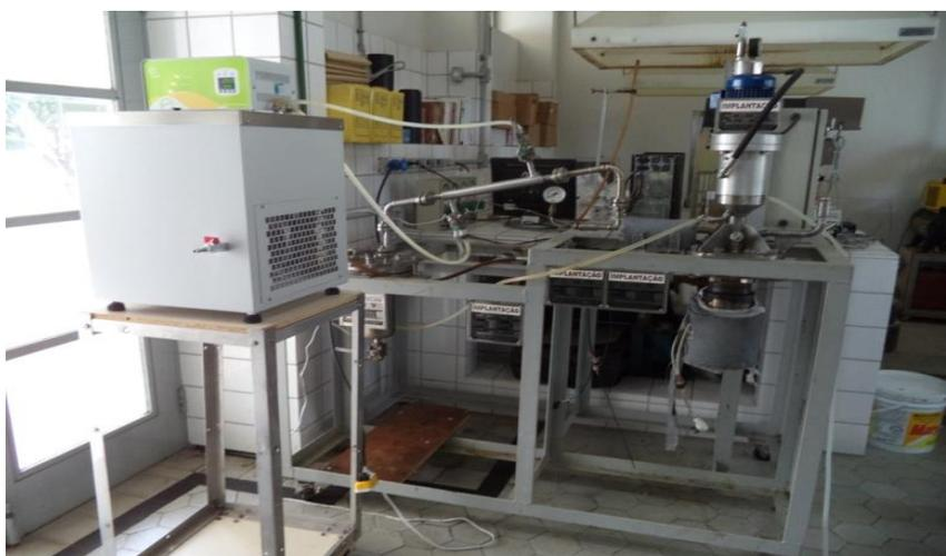
**Figura 4.19-** Unidade de Craqueamento em Escala Semi-Piloto (Laboratório de Catálise/IME).
