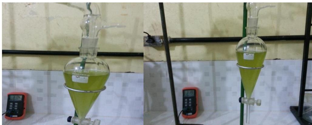
**Figura 4.42-** Frações Obtidas no Processo de Destilação na Unidade de Bancada.
