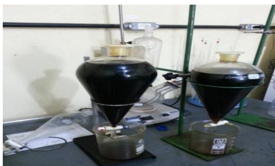
**Figura 4.38-** Processo de Decantação do PLO.
