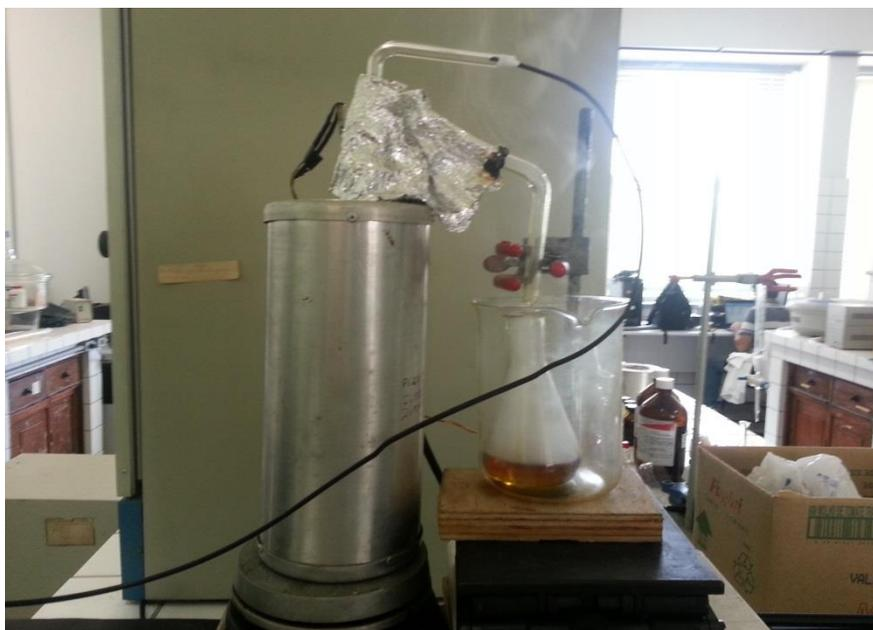
**Figura 4.17-** Forno Cilíndrico com Resistência Cerâmica.
