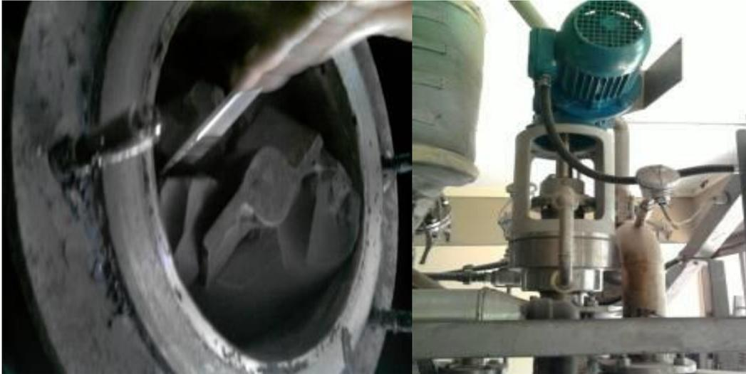
**Figura 4.28-** Sistema de Agitação da Unidade Piloto.
