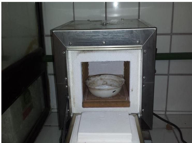
**Figura 4.12-** Secagem do Carbonato de Sódio na MUFLA.
