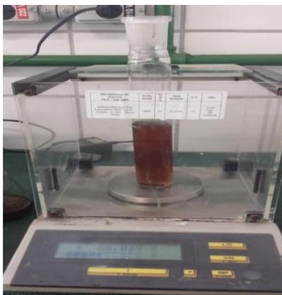
**Figura 4.16-** Gordura e Catalisador sendo pesados e colocados no Reator.
