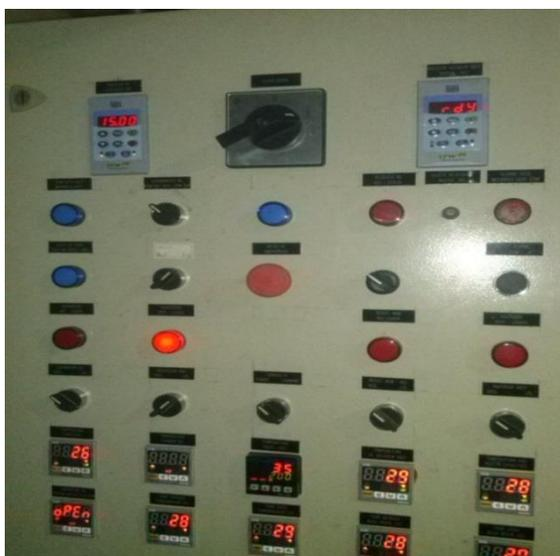
**Figura 4.32-** Painel do Sistema de Controle da Unidade Piloto de Craqueamento.
