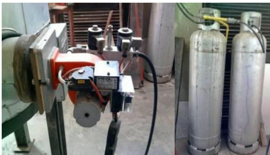
**Figura 4.26-** Sistema de Queima e os cilindros de armazenamento de GLP.
