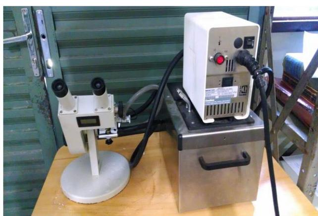
**Figura 4.47-** Refratômetro de ABBÉ.
