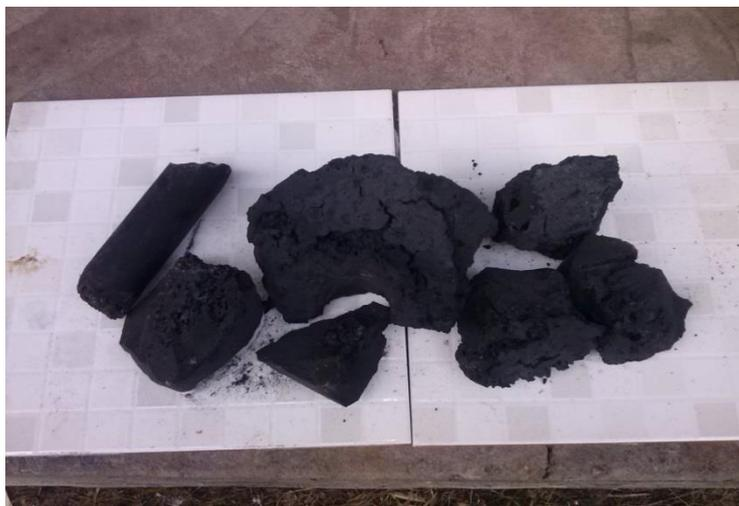
**Figura 4.36-** Coque retirado do Reator após a reação de Craqueamento.
