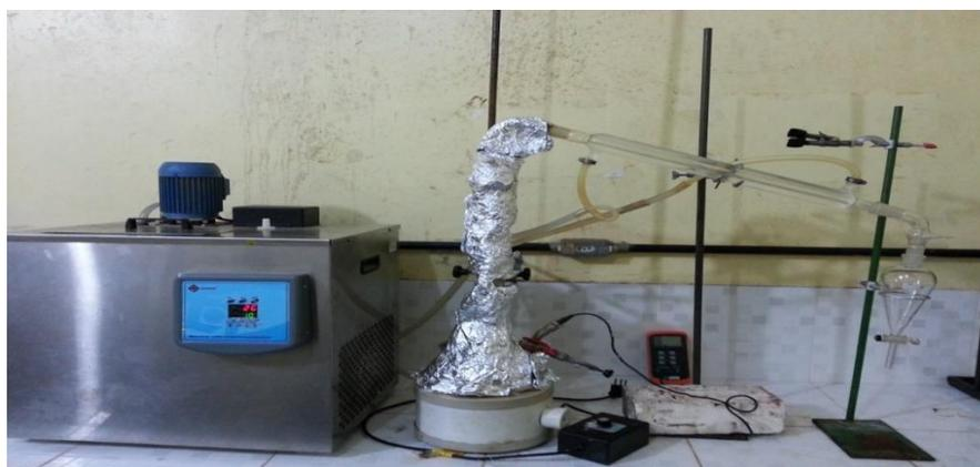
**Figura 4.41-** Unidade de Destilação Fracionada em Escala de Bancada.
