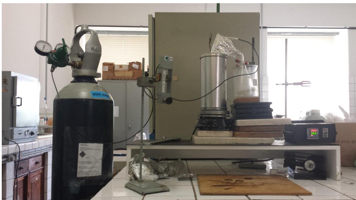
**Figura 4.14**- Unidade de Craqueamento em Escala de Bancada (Laboratório de Catálise/IME).
