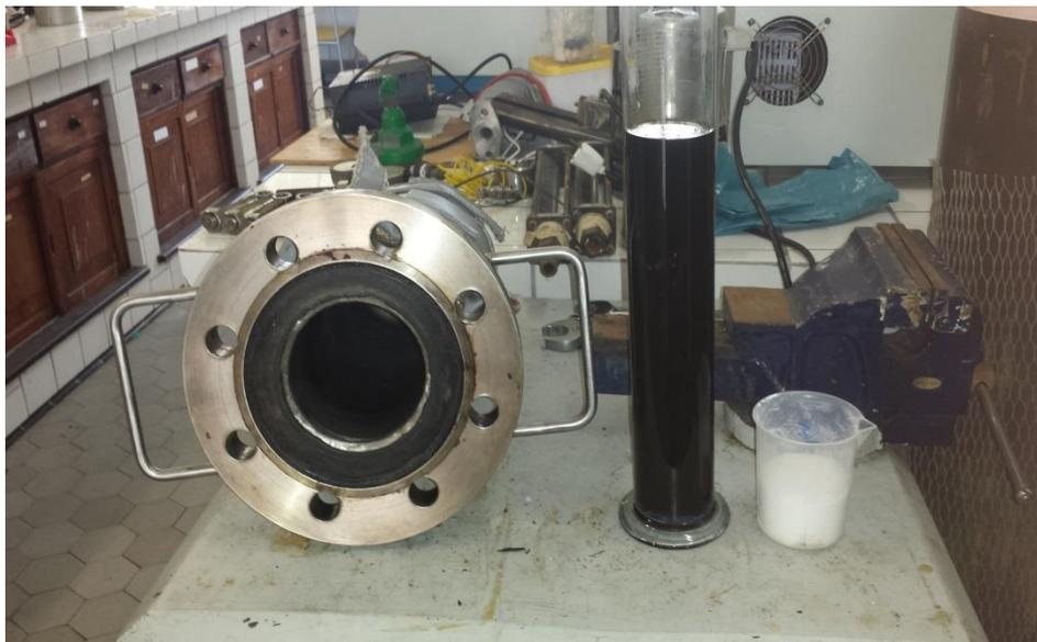
**Figura 4.21-** Gordura Residual e Carbonato de Sódio sendo depositados no Reator.
