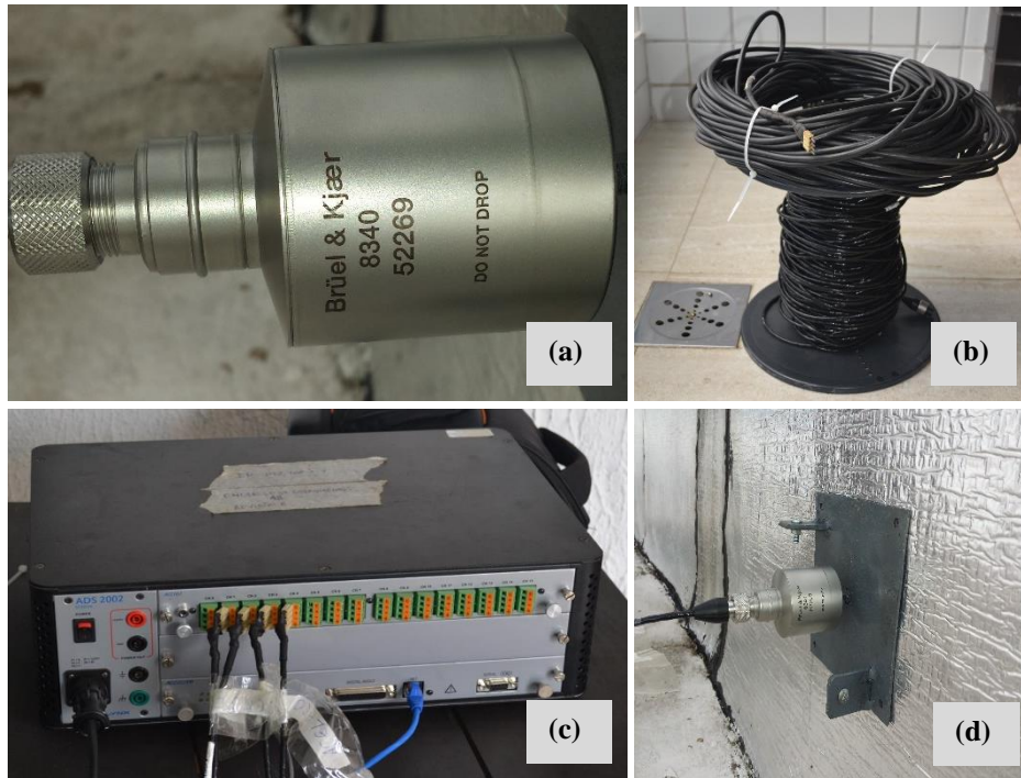
Figura 4.7 - Materiais utilizados para a instrumentação (acelerômetro piezoelétrico): (a) acelerômetro, (b) cabos para acelerômetros, (c) ADS, (d) placa metálica
